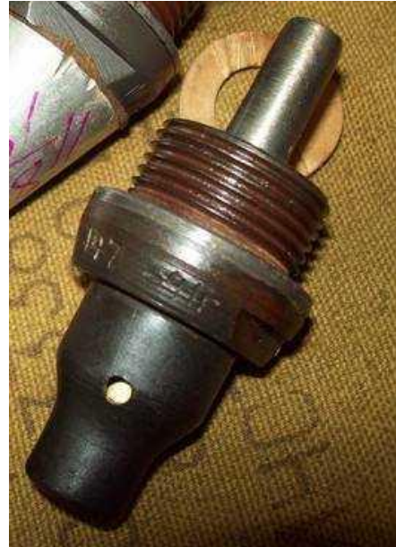
Рисунок 3.117 – Донний підрильник МД-7 незапобіжного типу:
