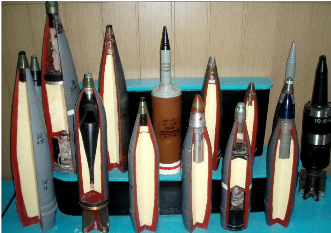
Рисунок 1.14 – Снаряди до пострілів роздільно-гільзового заряджання (вигляд у розрізі)
