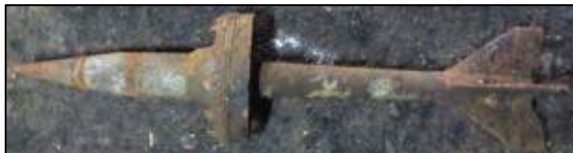
115 мм артилерійський снаряд (бронебійно- підкаліберний оперений снаряд з відкидним піддоном)
