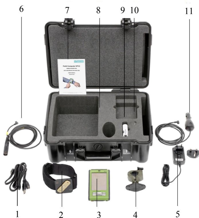
Рис. 5.9. Комплектність польового комп'ютера VFC-2: 1 – USB з'єднувальний кабель; 2 – ремінь кріплення приладу на руці оператора; 3 – польовий комп'ютер VFC-2; 4 – кріплення приладу для металодетектора EL1302D2 VALLON; 5 – зарядний пристрій для батарей; 6 – з'єднувальний кабель для передачі даних польовому комп'ютеру VFC-2; 7 – інструкція користувача; 8 – кейс для транспортування та зберігання; 9 – USB-носій інформації; 10 – ключ шестигранник; 11 - кабель для зарядки батарей від автомобільного прикурювача
