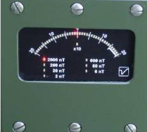
Рис. 5.7. Аналогове відображення напруги на дисплеї блоку керування
