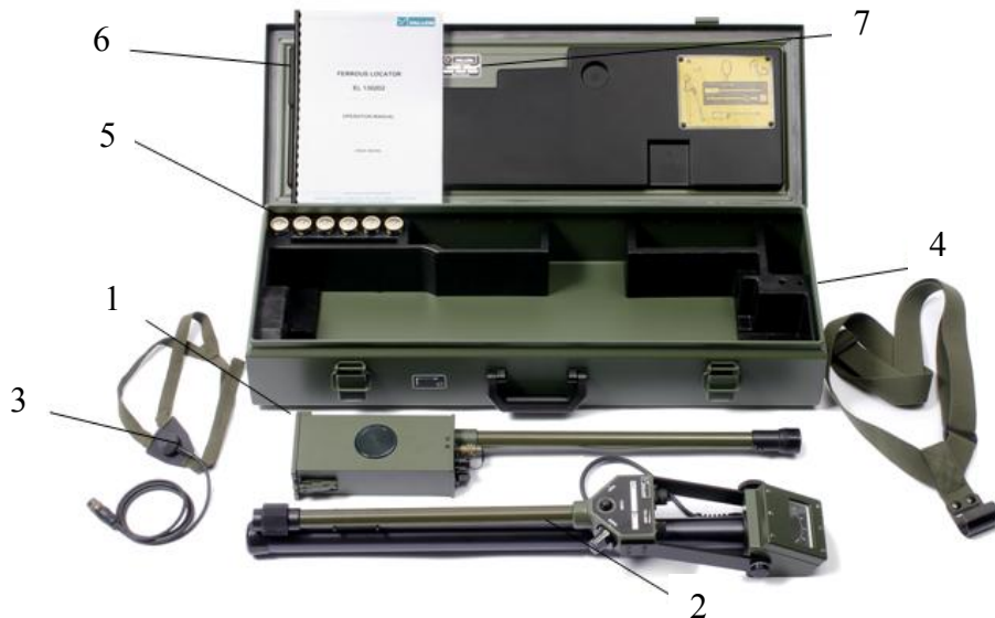
Рис. 5.6. Комплектність металодетектора EL1302D2 VALLON:
