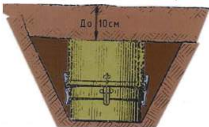
Малюнок 8.7.2 – Встановлення міни МЛ-2 в ґрунті
