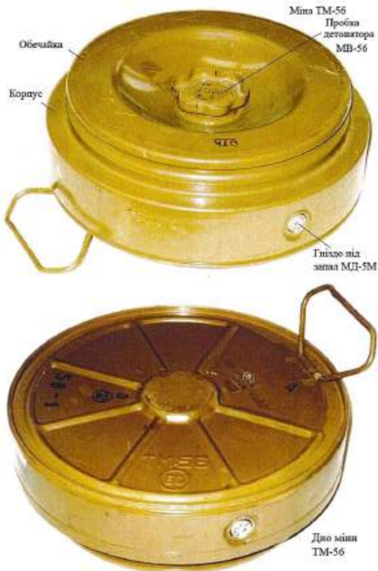
Малюнок 1.2.1 – Міна ТМ-56. Добре видно маркування і ручку для перенесення
