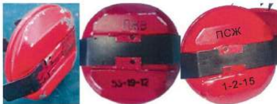
Малюнок 13.4.1 – Зліва – залізнична петарда випуску до 2008 року; В центрі і справа – випуску після 2008 року
