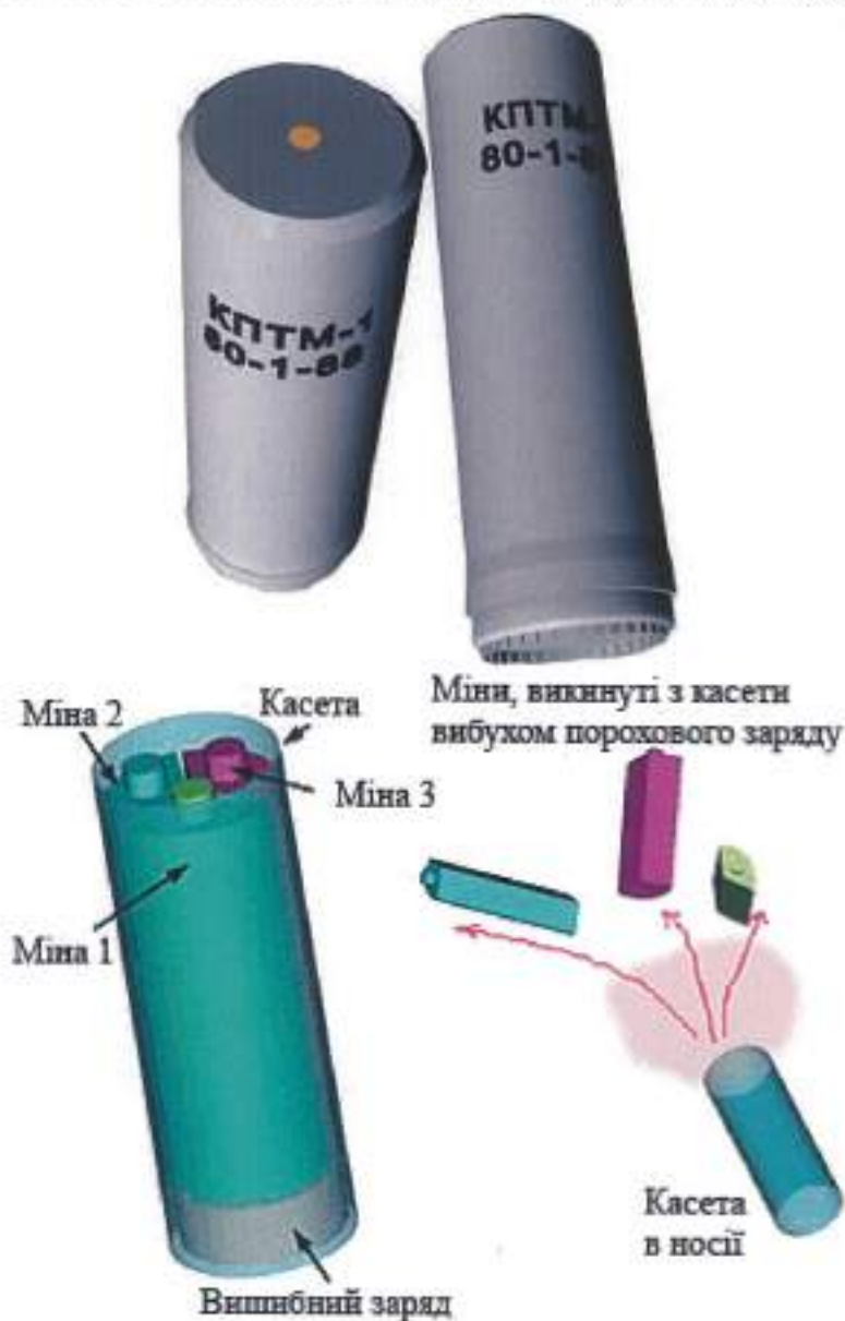
Малюнок 1.11.2 – Міни ПТМ-1 в касеті КПТМ-1 та принцип дії касети
