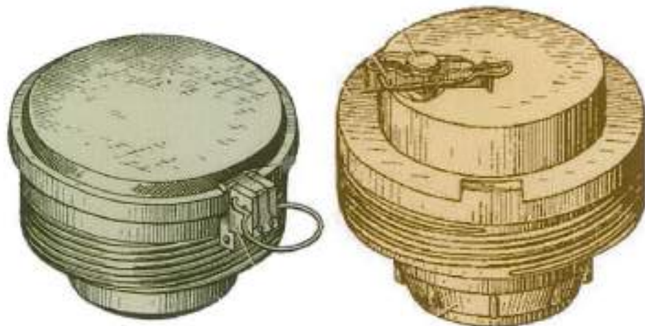
Малюнок 1.4.5 – Детонатор МВД-62 зліва та МВП-62М справа міни ТМ-62М
