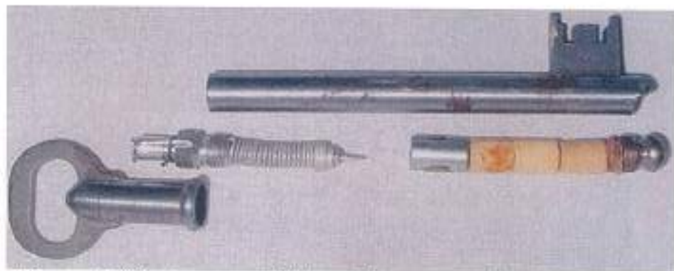
Малюнок 8.10.2 – Детонатор МВ-1, в розібраному стані. Заряд ВР – жовтого кольору
