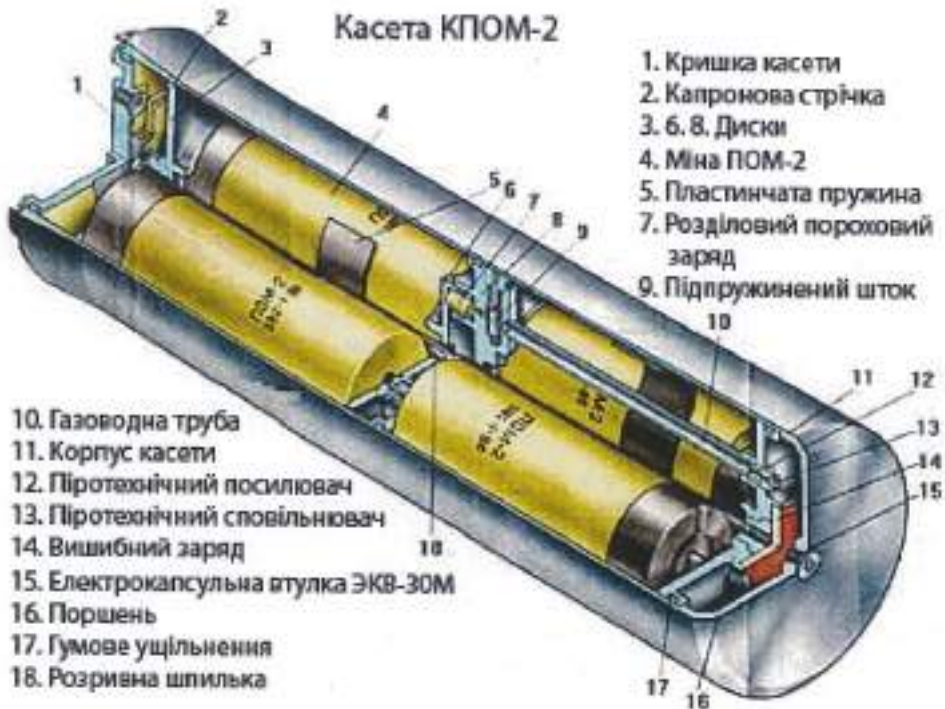
Малюнок 6.7.3 – Касета КПОМ-2, внутрішня будова
