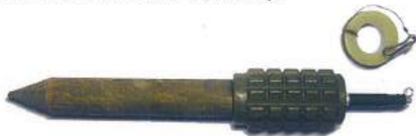
Малюнок 6.2.1 – Міна POM3-2M, з детонатором МУВ-2 та дротом для натягнення на катушці
