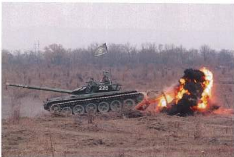
Малюнок 2.2.5 – Розмінування ТМ-89 за допомогою мінного траку, ЧРІ
