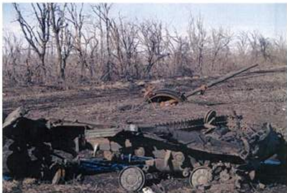
Малюнок 2.2.3 – Т-64Б після проїзду над міною ТМ-89, від детонації БК корпус розірвано, башта відкинута на 20 м ліворуч від танка
