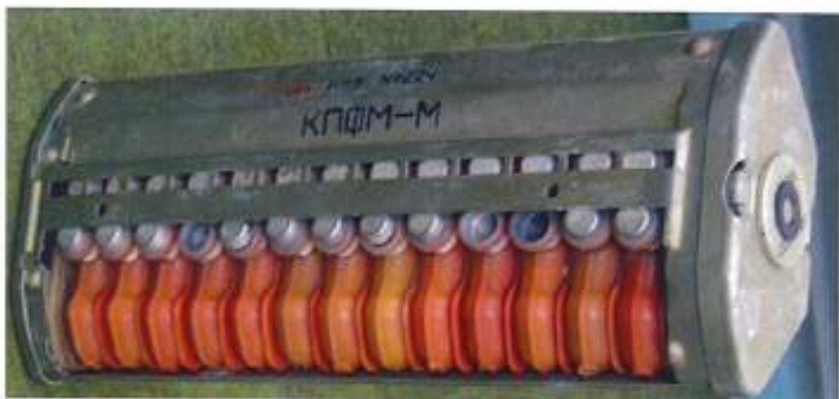
Малюнок 5.6.8 – Головна частина ракети 9М27КЗ і касета КПФМ-М на 26 мін
