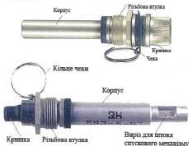
Малюнок 9.5.2 – Детонатори ВЗД-1М (зверху) та ЗН (знизу)
