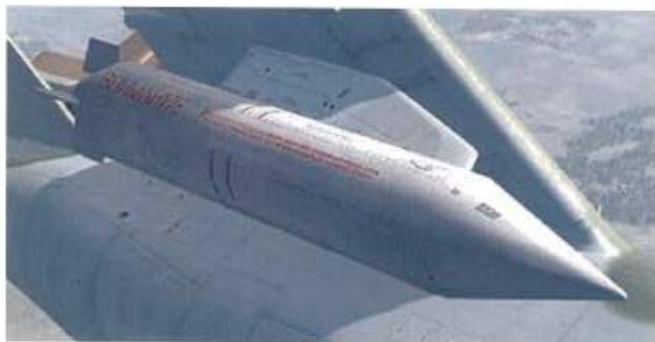
Малюнок 5.6.7 – Авіаційний контейнер КМГУ на зовнішній підвісці літака
