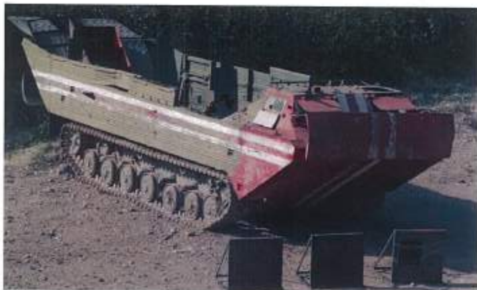
Малюнок 7.4.6 – Перед ПТС встановлено 6-и мм та 4,5-и мм броньові плити
