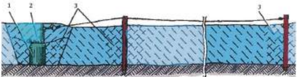
Малюнок 6.3.3 – Встановлення міни ОЗМ-3 в сніг: 1 – міна; 2 – маскувння снігом; 3 – утрамбований сніг
