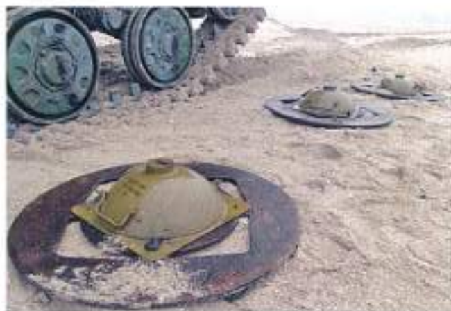
Малюнок 11.2.2 – Міни ПДМ-1М, підготовлені до установки, Маріуполь 2014 р
