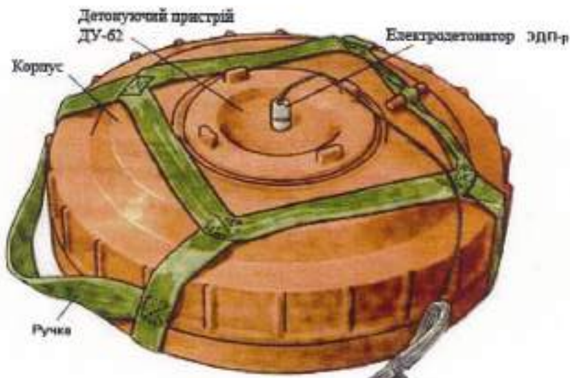
Малюнок 1.6.2 – Міна ТМ-62П2 з електродетонатором ЭДП-р, та детонуючим пристроєм ДУ-62
