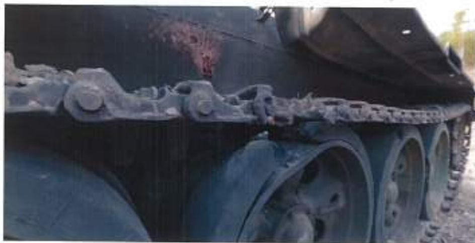
Малюнок 3.2.7 – Дія ТМ-83: пошкоджено каток, гусеницю, борт не пробито, тому що УЯ попало в трак і роздвоїлось, завдяки силі пробиття
