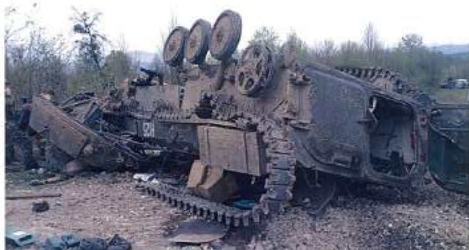
Малюнок 1.10.3 – БМП після підриву на міні ТМ-62Д, силою вибуху машину розірвало і перекинуло на дах, ЧРІ, 1995 рік
