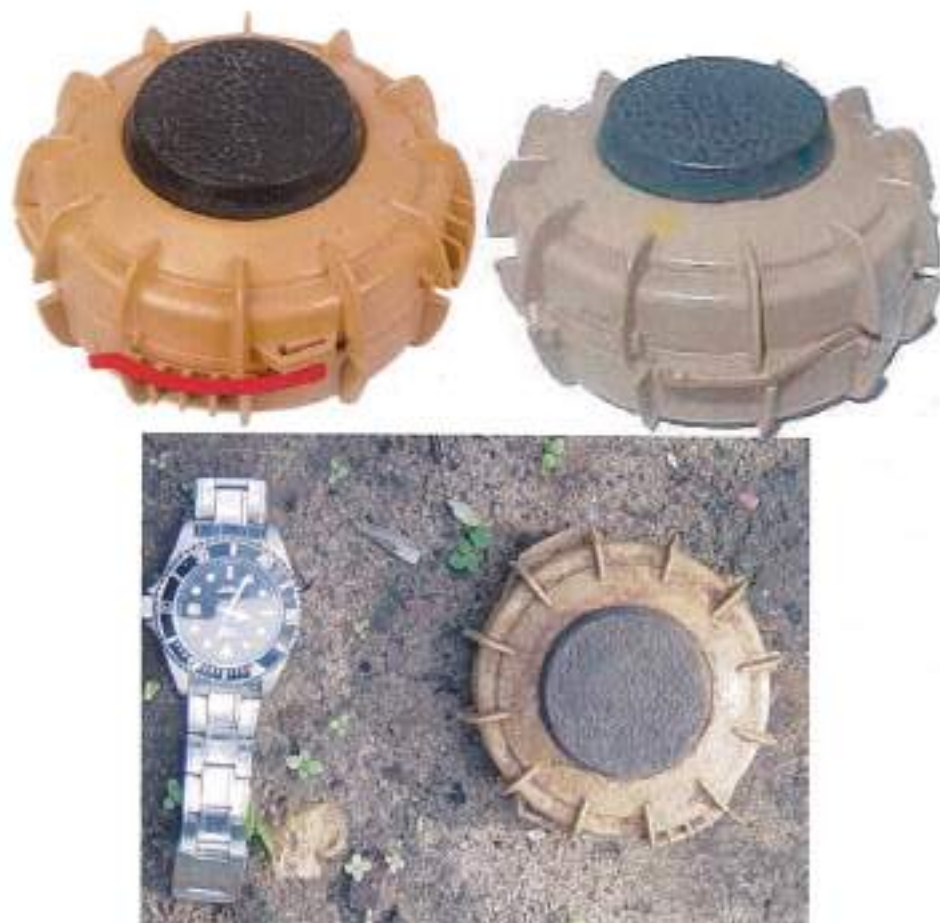
Малюнок 5.9.1 – Міна УМ-ІВ. Варіанти забарвлення. Зверху зліва на міні – запобіжний стопор червоного кольору. Знизу – міна на ґрунті та її порівняльний розмір
