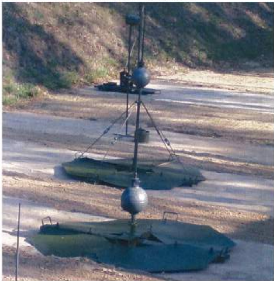
Малюнок 11.3.1 – Міни ПДМ-2, підготовлені до установки, на низькій підставці (на передньому плані) та на високій підставці (на задньому плані). ВР в сфері.
