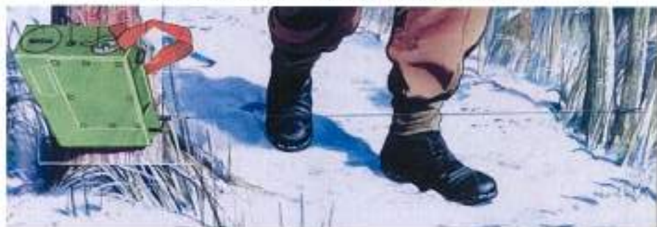
Малюнок 6.5.4 – Детонатор MBZ-NC з обривним дротом
