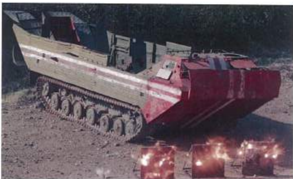
Малюнок 7.4.7 – Попадання ГЗЕ від міни МОН-90 в вищевказані броньові плити та корпус ПТС-2. Броньові плити пробито, лоб корпусу ПТС-2 завтовшки 5 мм з неброньової сталі пробито в багатьох місцях
