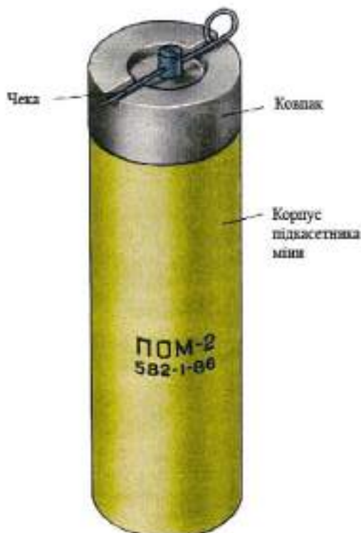
Малюнок 6.7.4 – металевий циліндр – підкасетник міни ПОМ-2
