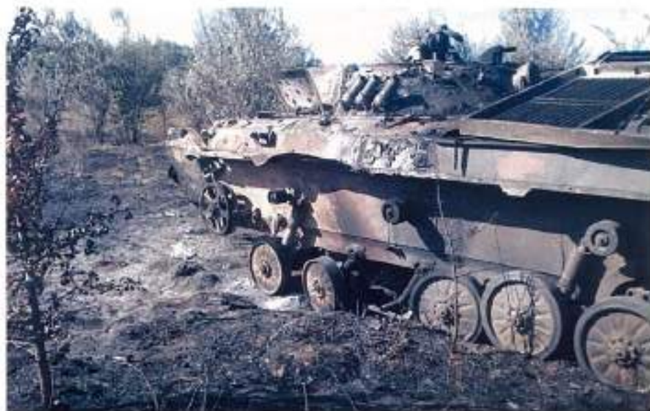
Малюнок 1.9.5 – 18.07.2016 р. Кримське, Схід України, БМП-2К після підриву на міні ТМ-62Т, машина згоріла, 93 ОМБр
