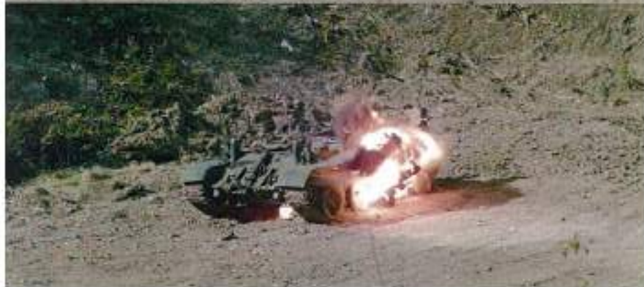
Малюнок 3.2.5 – Відеорозкадрування влучання УЯ міни ТМ-83 в борт БРСМ. Ч.1. По білому кольору вогню зрозуміло, що температура 5-7 тисяч градусів.
