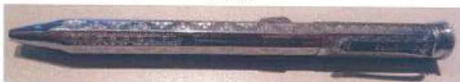
Малюнок 8.10.2 – Детонатор МВ-1, в розібраному стані. Заряд ВР – жовтого кольору
