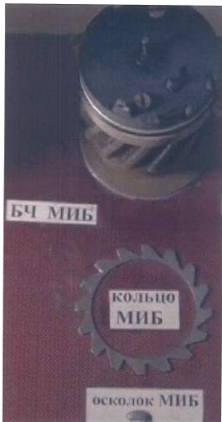
Малюнок 6.10.2 – Сталеві кільця міни МИБ, з яких, при підриві утримуються осколки
