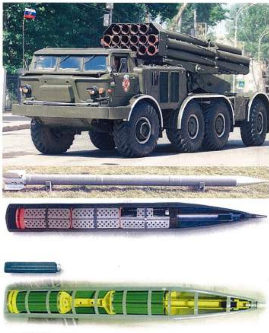
Малюнок 1.11.3 – РСЗВ 9К57 «Ураган» та його ракети 9М27К2, 9М27К3 з касетними протитанковими бойовими частинами, оснащенними мінами ПТМ-1 або ПТМ1-Г в три яруси
