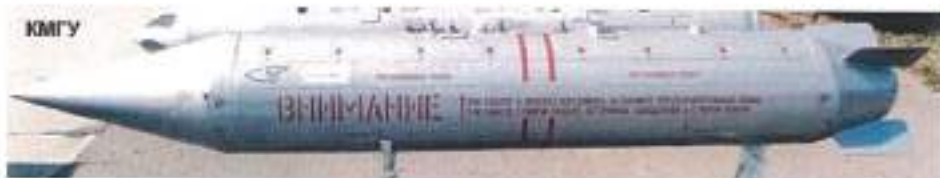
Малюнок 6.6.4 – Міна ПОМ-1 в контейнері КМГУ для підвішування на штурмовій літаку
