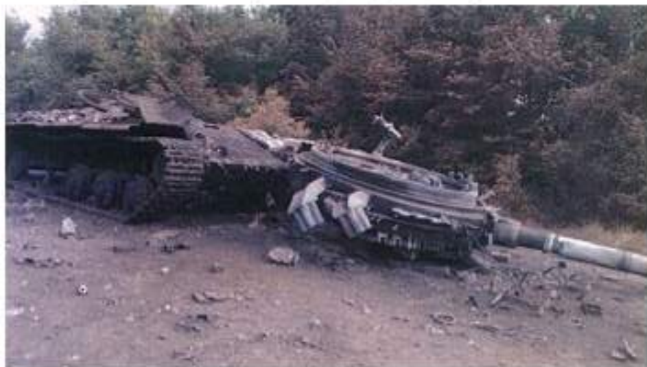
Малюнок 2.2.2 – Т-64БВ після проїзду над міною ТМ-89, днище пробито кумулятивним струменем, від якого виникла детонація БК, яка зірвала башту з погону
