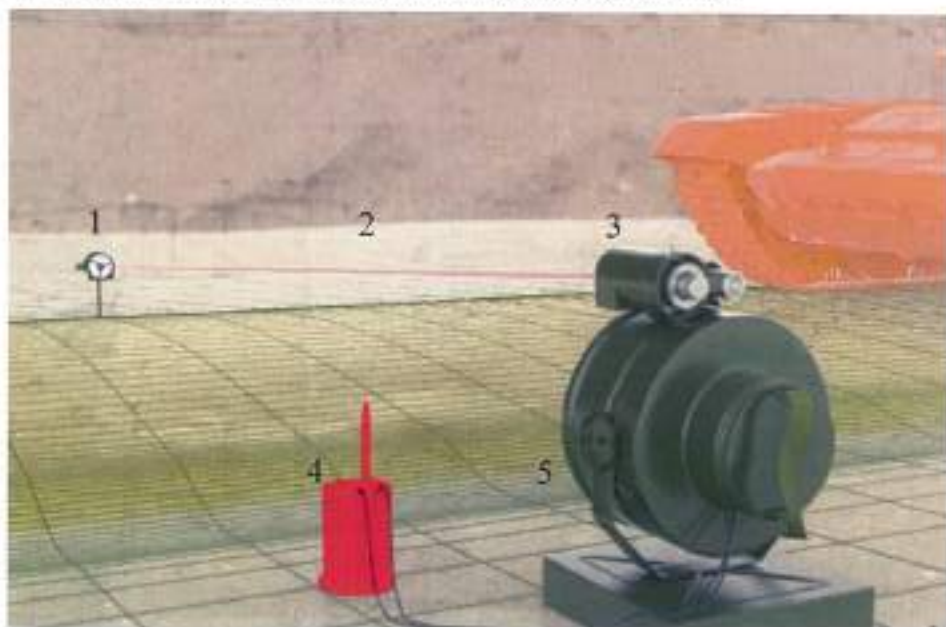
Малюнок 3.2.3 – Робота міни ТМ-83: 1. Відбивач; 2. ІЧ-промінь; 3. ІЧ-датчик; 4. Сейсмічний датчик; 5. Міна ТМ-83.
