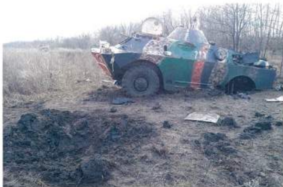
Малюнок 1.9.4 – 03.12.2015 р. Гуцутово, Схід України, БРДМ-2 після підриву на міні ТМ-62Т, заднього моста відірвано, 9 ОМПБ
