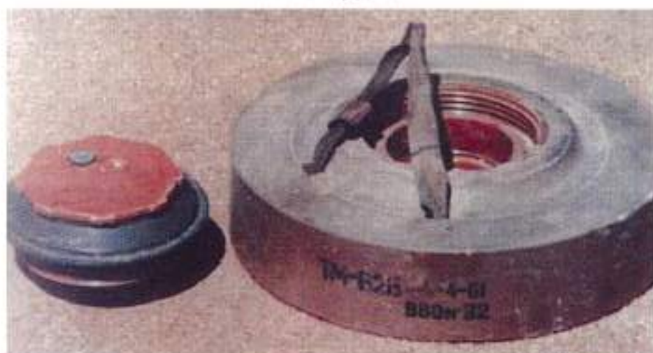
Малюнок 1.9.3 – Міна ТМ-62Б. Добре видно колір, впресовану ручку для переноски; зліва – детонатор МВЧ-62
