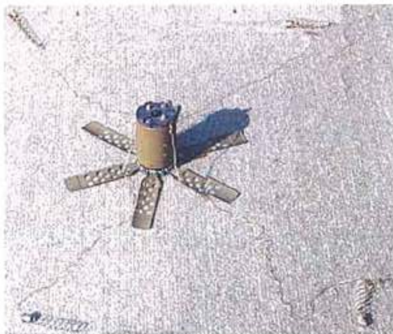
Малюнок 6.7.1 – Міна POM-2 в бойовому положенні. Добре видно всі чотири розтяжки – датчики цілі
