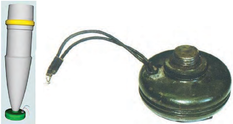
Малюнок 7.2.1 – Міна «ОЗМ с УВК» в зборі – зліва, та універсальна вишибна камера – справа
