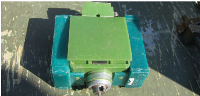
Малюнок 8.8.3 – Міна МЛ-7, загальний вигляд
