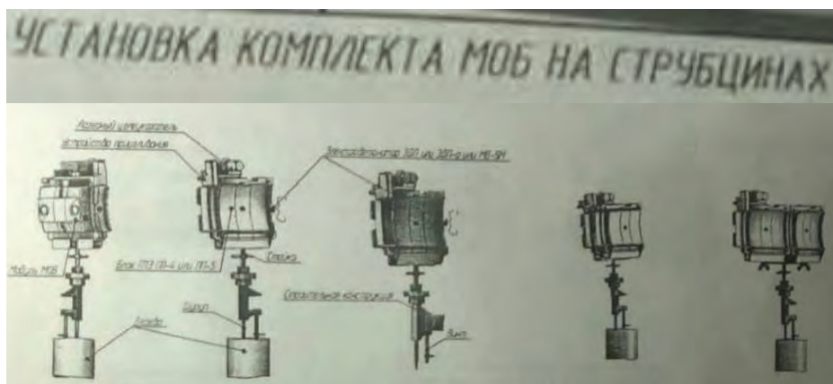
Малюнок 7.7.7 – Установка МОБ на струбцинах (з інструкції з експлуатації АО НІІІІ та МО РФ); варіанти установки з одним модулем, двома тандемними модулями та двома модулями в ряд
