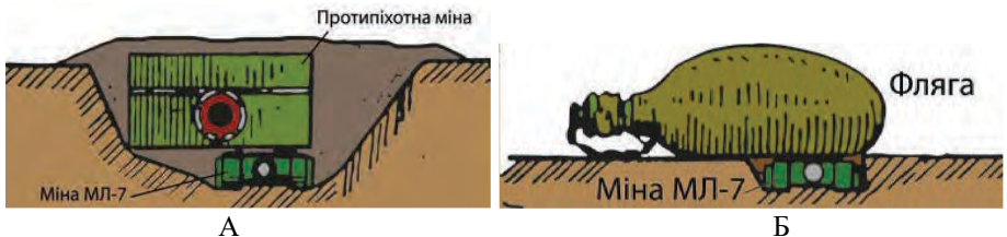
Малюнок 8.8.2 – А: Міна МЛ-7, встановлена в якості пристрою невитягування;
