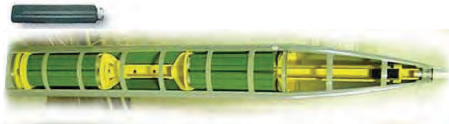
Малюнок 1.11.3 – РСЗВ 9К57 «Ураган» та його ракети 9М27К2 та 9М27К3 з касетними протитанковими бойовими частинами, оснащеними мінами ПТМ-1 або ПТМ1-Г в три яруси
