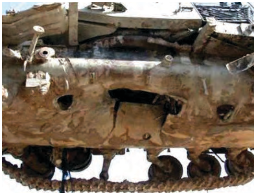
Їзраїльський танк Magach-7 з пробоїною від міни TM-72, Південний Ліван
