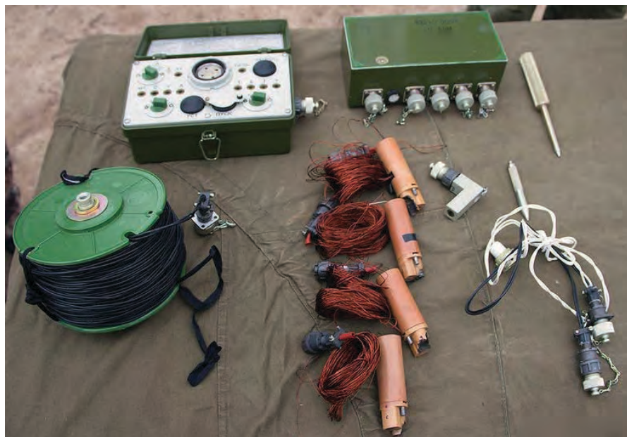
Малюнок 7.11.2 – НВУ-П2, в повному комплекті
