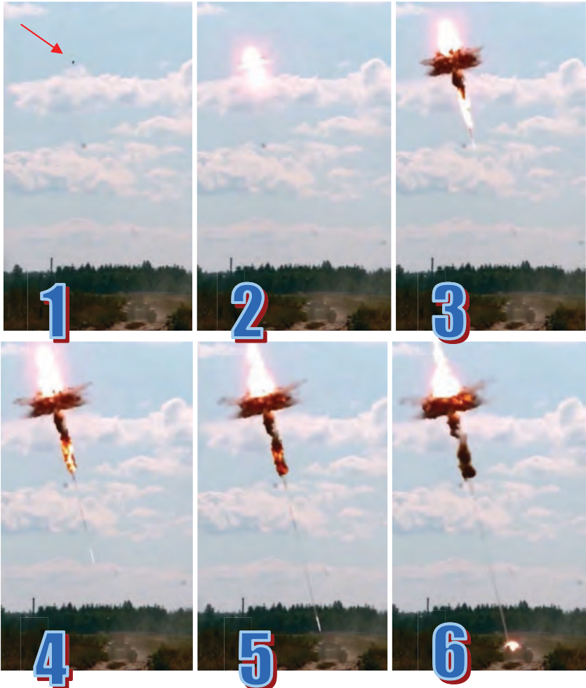
Відеорозкадровка польоту бойової частини міни: 1- пошук цілі; 2 - підрив БЧ; 3,4,5 - формування та політ УЯ; 6 - влучання в ціль
