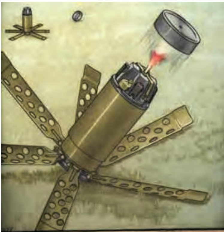
Малюнок 6.7.7 – Міна ПОМ-2, відстріл кришки та розкриття підпружинених лап
