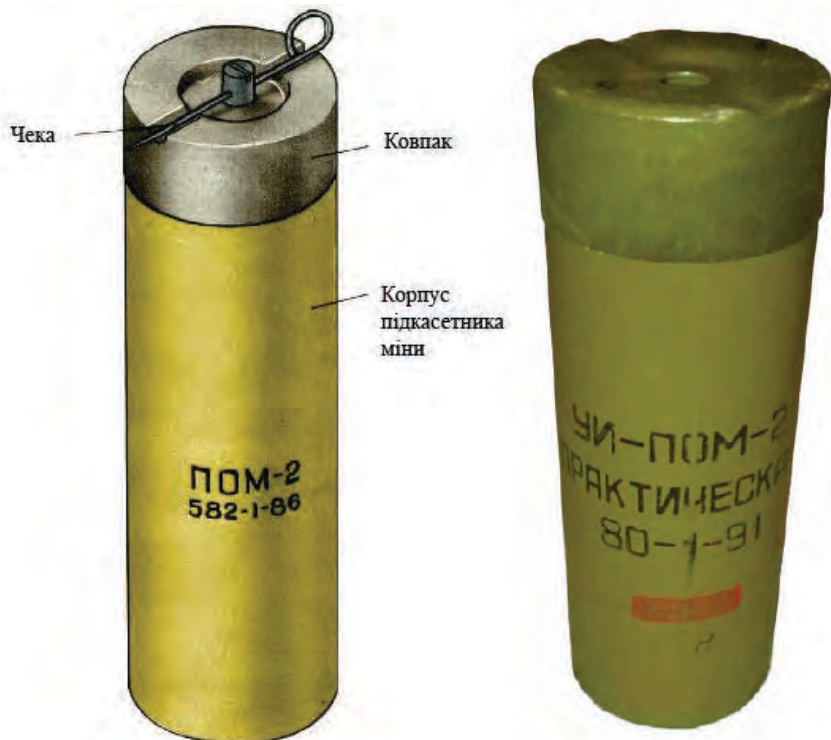
Малюнок 6.7.4 – Металевий циліндр – підкасетник міни ПОМ-2
