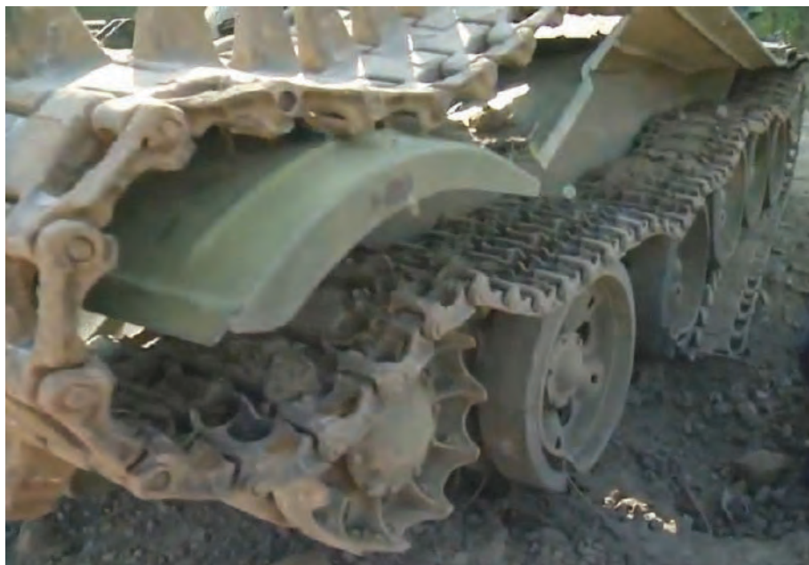
Малюнок 1.4.3 – Дія міні ТМ-62М після вибуху на попередньому фото: розірвана та відкинута гусениця, пошкоджено 2 катки
