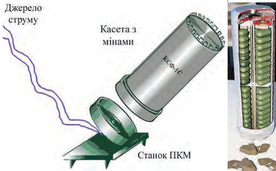
Малюнок 5.6.2 – Касета КСФ-1С: схема та розріз
