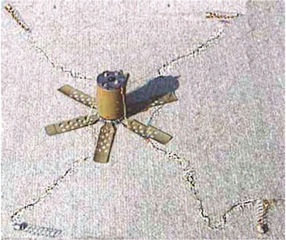
Малюнок 6.7.1 – Міна POM-2 у бойовому положенні. Добре видно всі чотири розтяжки – датчики цілі
