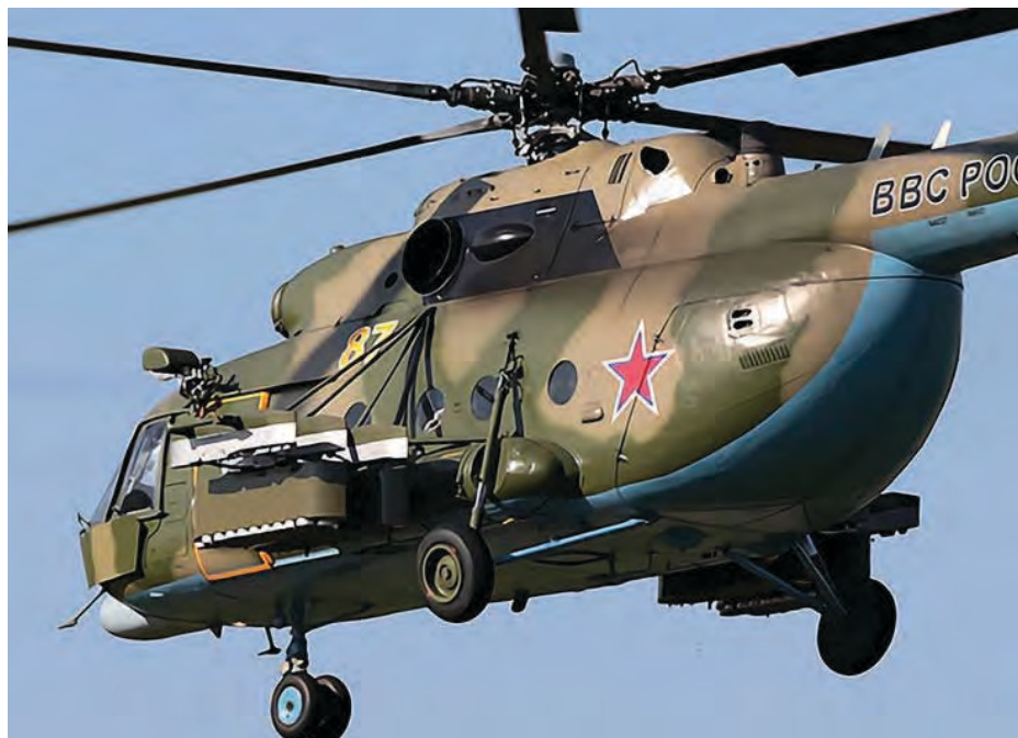
Малюнок 5.6.6 – Мінний загороджувач ВСМ-1 на гелікоптері Мі-8 з касетами КСФ на зовнішній підвісці
