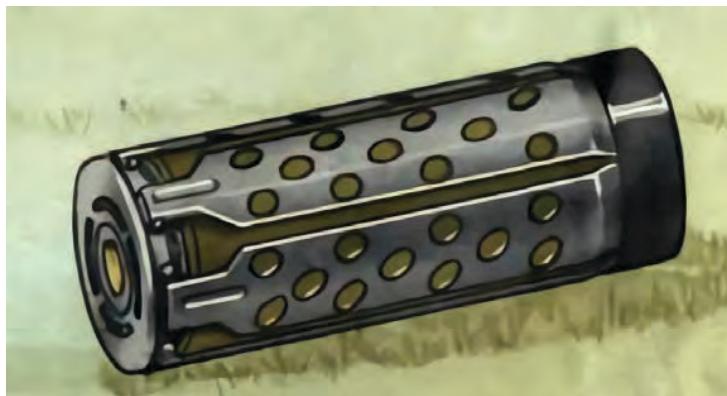
Малюнок 6.7.6 – Міна ПОМ-2, виштовхнута з підкасетника
