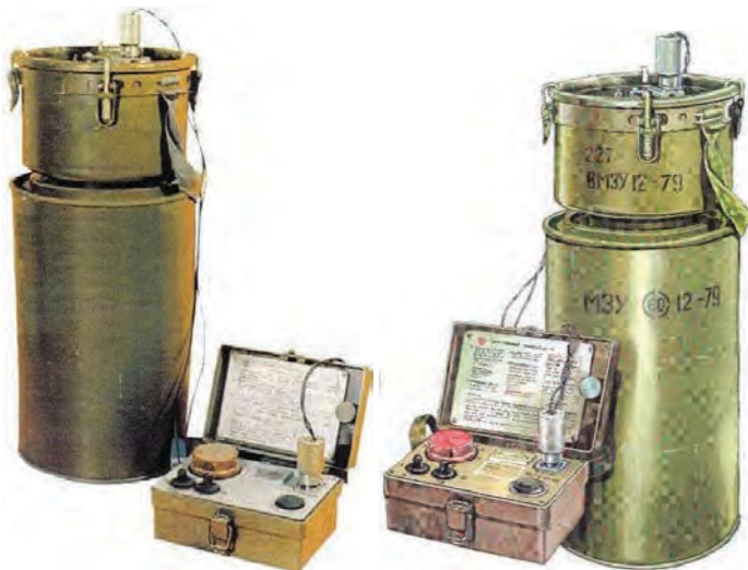
Малюнок 10.1.1 – Міна МЗУ з пультом керування «МЗУ», який використовується і для НВУ-П і для міни ТМ-83 – зліва; МЗУ-С – справа
