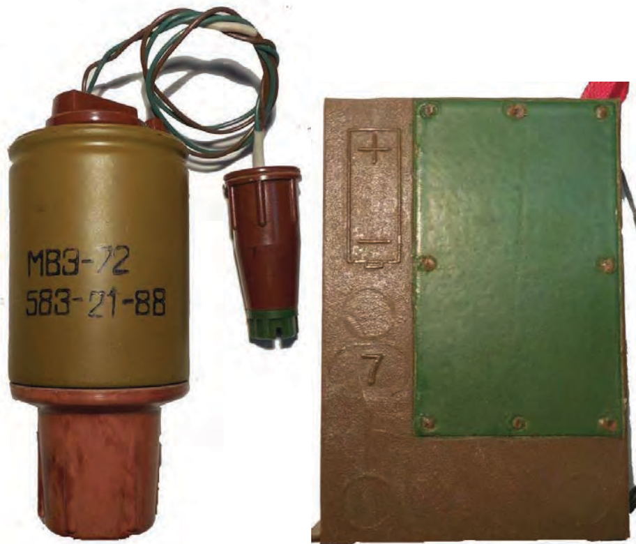
Малюнок 6.5.3 - Підривачі МВЗ-72 та МВЗ-НС
