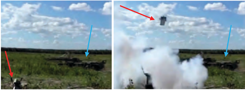
Малюнок 4.2.5 – Зліва, міна на позиції (червона стрілка) захоплює ціль (синя стрілка); Справа, відстріл бойового елементу, в бік цілі (червона стрілка)
