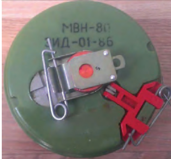
Малюнок 1.4.11 - Міна ТМ-62М з підривачом МВН-80, знизу - підривач МВН-80
