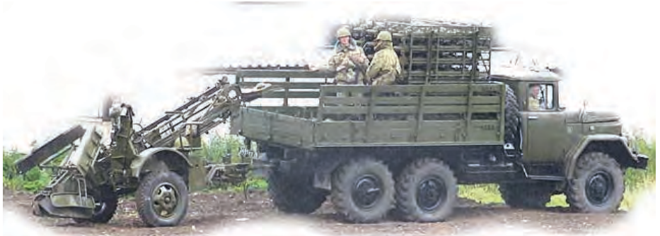
Малюнок 15.3.1 – Мінний загороджувач ПМЗ-4П, причеплений до ЗІЛ-131
