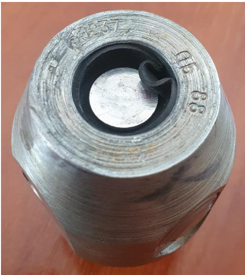
Загальний вид вибухника (вид зверху) – не зведений!
