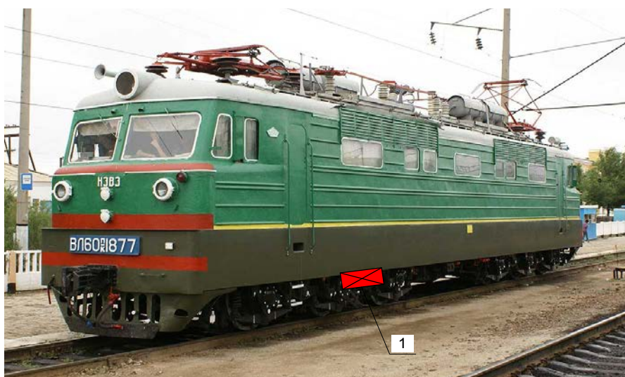
Мал. 171. Підривання електровоза: 1 – заряд на моторно-осьових підшипниках.
