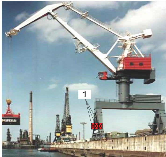
Мал. 192. Підривання портового крана: 1 – заряд на прикордонній нозі крана.
