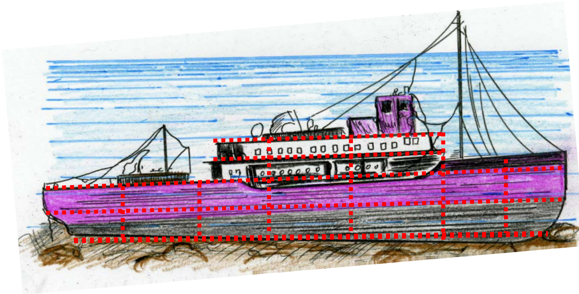
Мал. 224. Розмітка ліній підривання для поділу корабля водотоннажністю більше 2000 т (позначено пунктиром).
