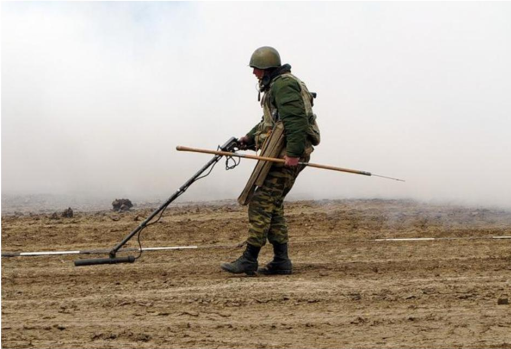
Пошук мін за допомогою індукційного міношукача ІМП та мінного щупа
