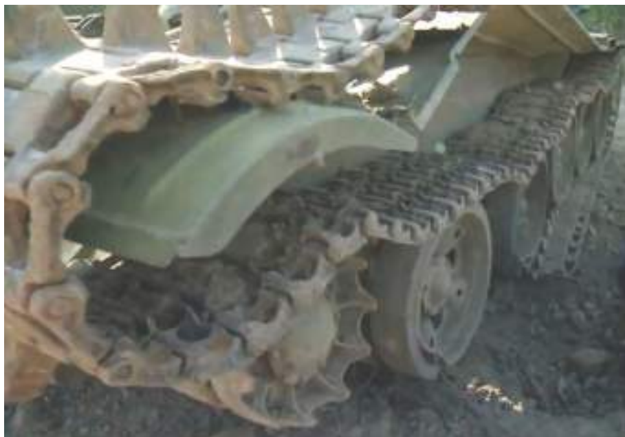
Малюнок 1.4.3 – Дія міни ТМ-62М після вибуху на попередньому фото: розірвана та відкинута гусениця, пошкоджено 2 катки
