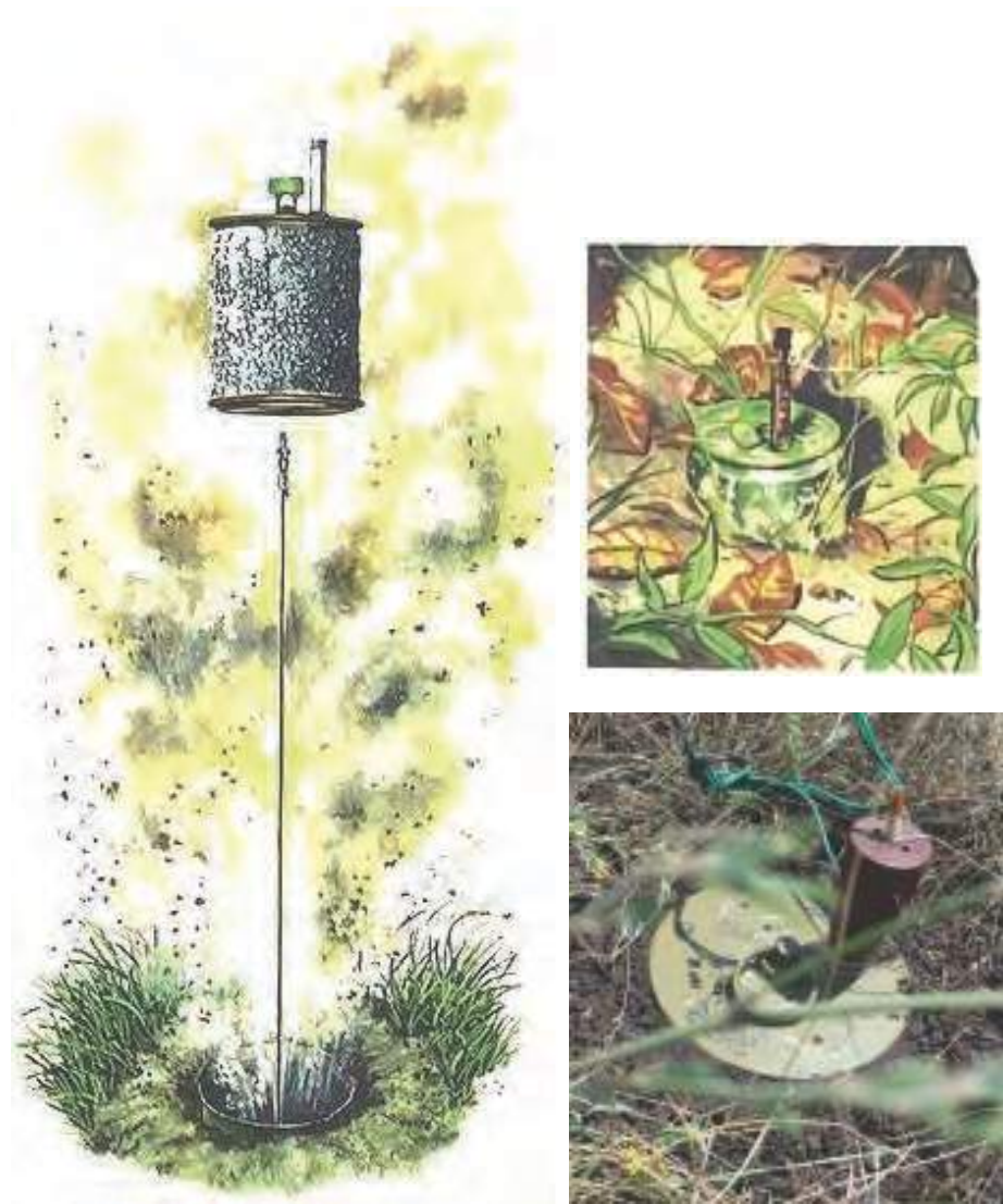
Малюнок 6.5.5 – Зліва: підриєв ОЗМ-72; Справа: маскування ОЗМ-72
