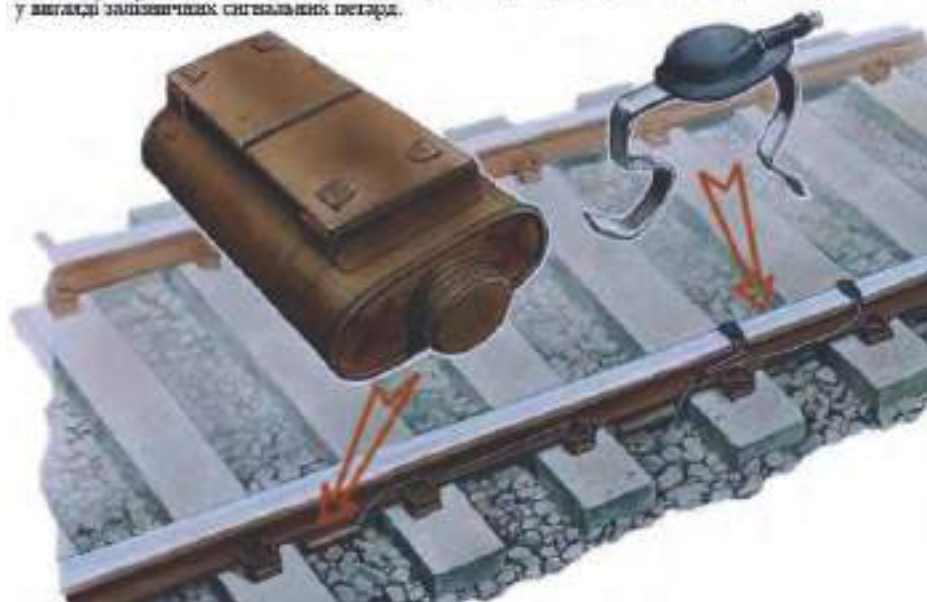
Малюнок 13.4.3 – Петарда в якості детонатора противотранспортної міни
