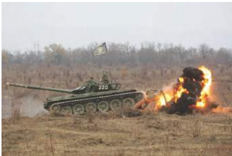
Малюнок 2.2.5 – Розмінування ТМ-89 за допомогою мінного тралу, ЧРІ
