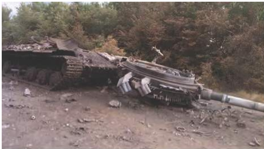
Малюнок 2.2.2 – Т-64Б після проїзду над міною ТМ-89, днище пробито кумулятивним струменем, від якого виникла детонація БК, яка зірвала башту з погону корпусу
