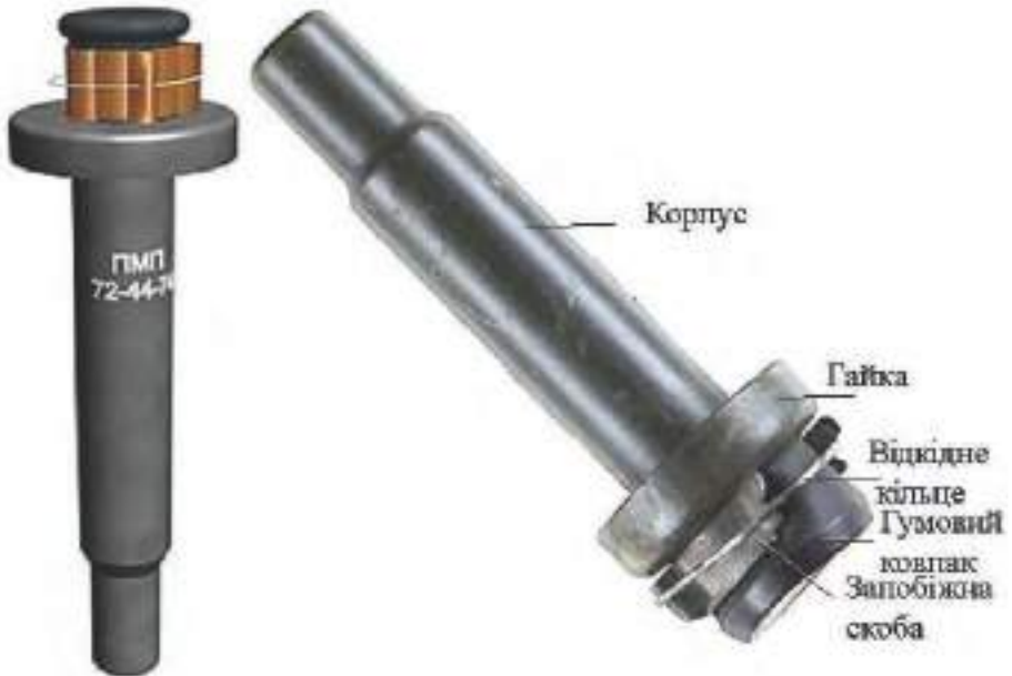
Малюнок 5.7.1 – Міна ПМП, загальний вигляд та деталі будови
