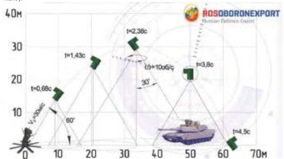
Малюнок 4.2.4 – Схема принципу роботи міни ПТКМ-1Р
