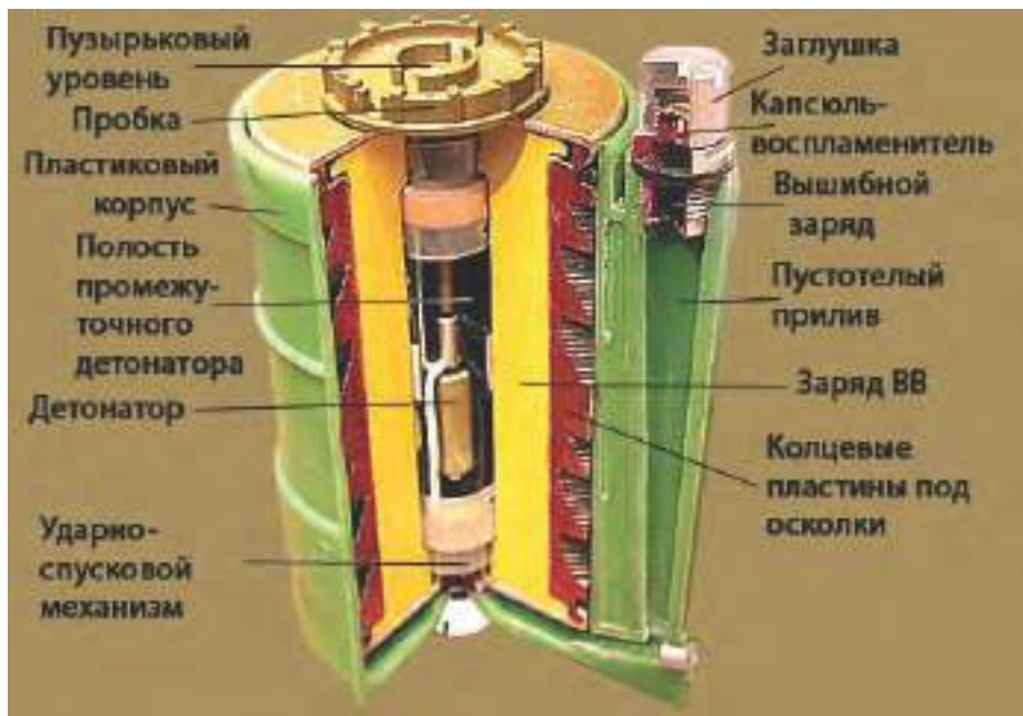
Малюнок 6.9.3 – Розріз міни ПОВ з виставки РФ ФГУП “НИИИ” г. Балашиха
