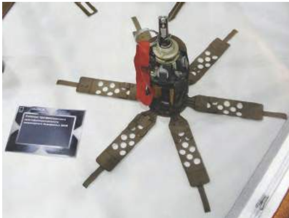
Малюнок 6.10.3 – Міна-граната МИБ, в бойовому положенні
