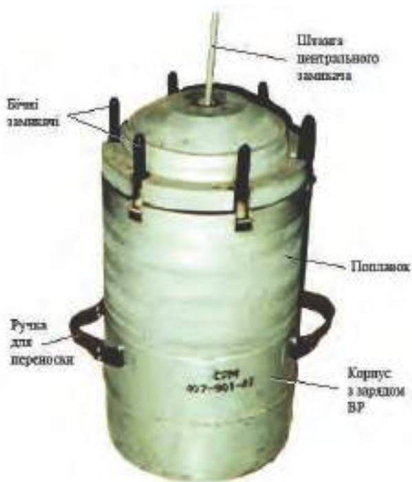
Малюнок 9.2.1 – Міна СРМ, загальний вигляд. На фото зліва добре видно довжину центрального датчика цілі
