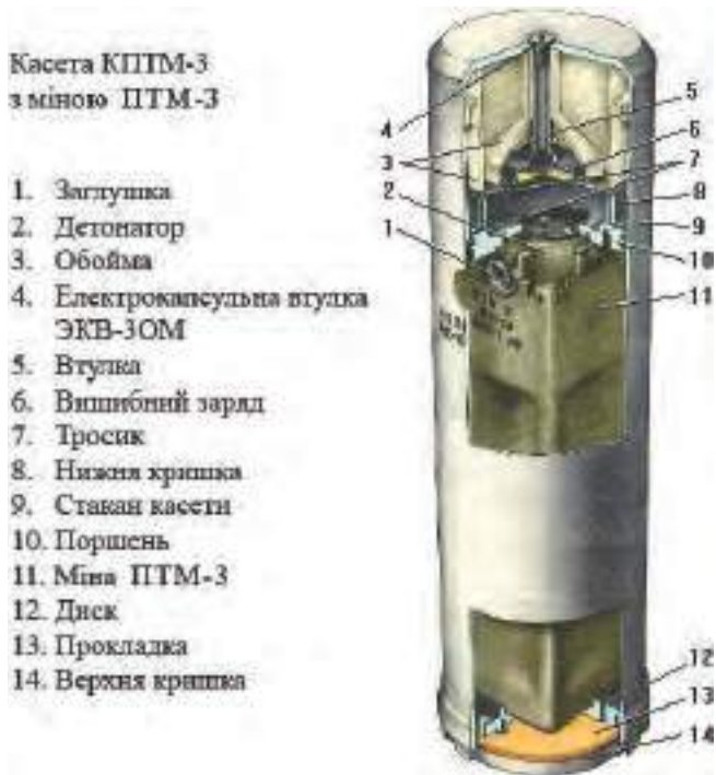
Малюнок 2.4.2 – Схема касети КПТМ-3 з міною ПТМ-3
