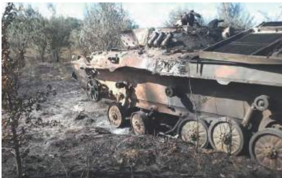
Малюнок 1.9.6 – 18.07.2016 р. Кримське, Схід України, БМП-2К після підриву на міні ТМ-62Б, машина згоріла, 93 ОМБр
