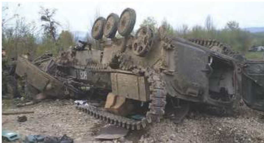
Малюнок 1.10.3 – БМП після підриву на міні ТМ-62Д, силою вибуху машину розірвало і перекинуло на дах, ЧРІ, 1995 рік
