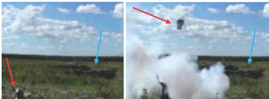
Малюнок 4.2.5 – Зліва, міна на позиції (червона стрілка) захоплює ціль (синя стрілка); Справа, відстріл бойового елемента, в бік цілі (червона стрілка)
