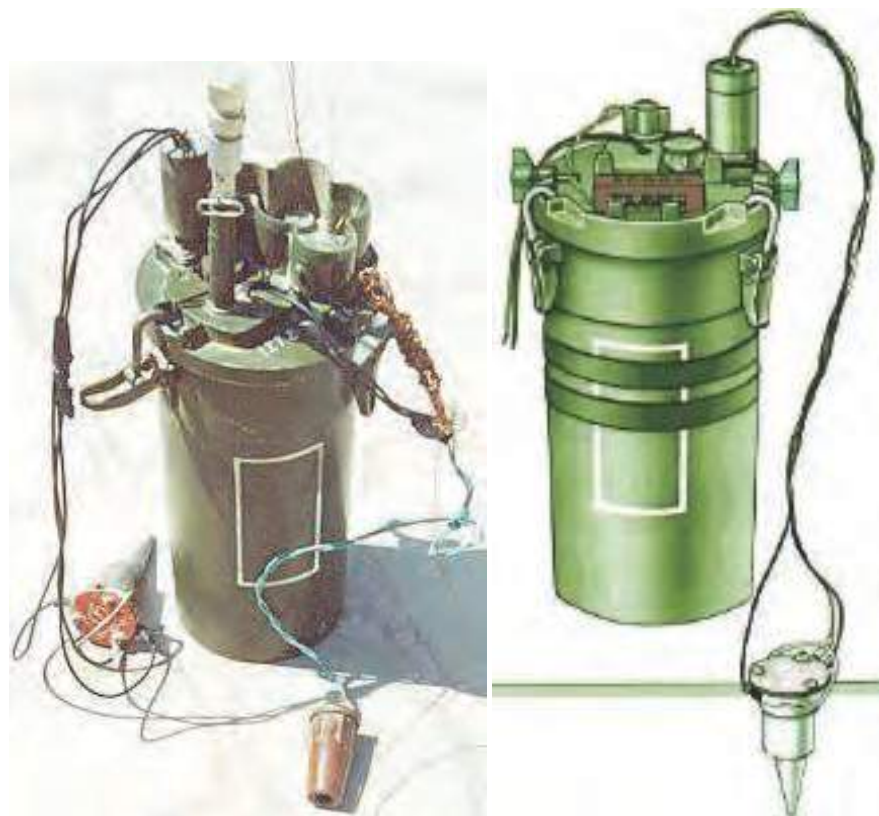
Малюнок 7.10.1 – Підриваючий пристрій НВУ-П, загальний вигляд – зліва, та підготовлений для перевірки працездатності з сейсмотатчиком
