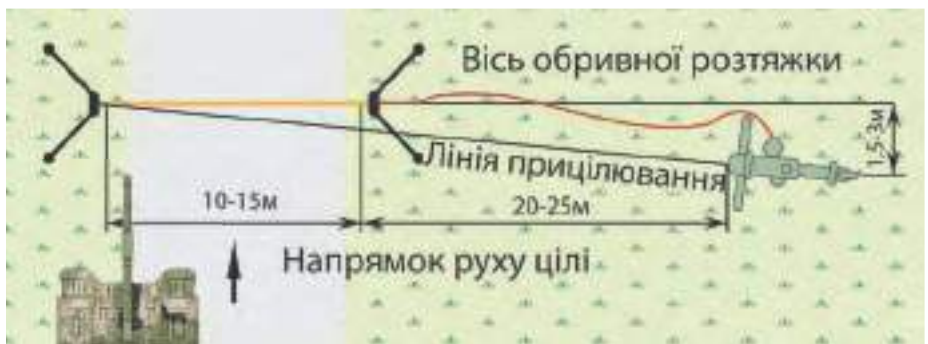
Малюнок 3.1.3 – Схема встановлення міни ТМ-73
