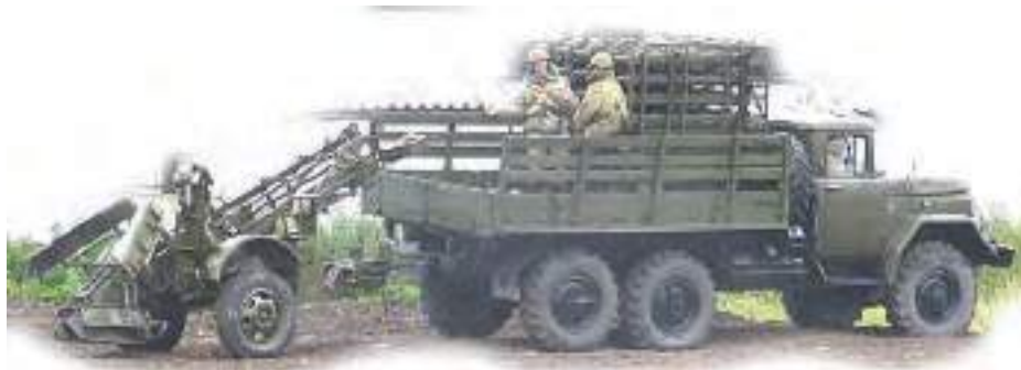
Малюнок 15.3.1 – Мінний загороджувач ПМЗ-4П, причеплений до ЗІЛ-131
