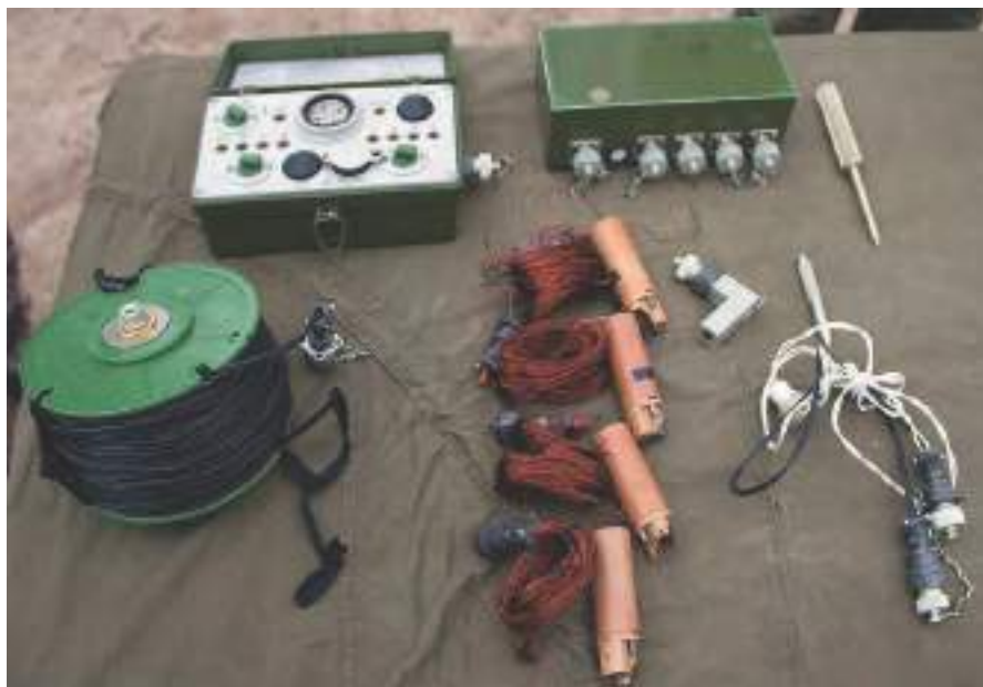
Малюнок 7.11.2 – НВУ-П2, в повному комплекті
