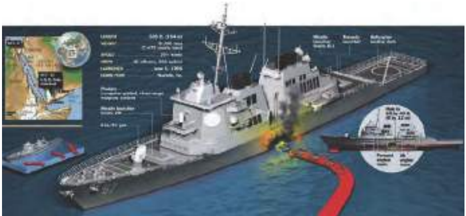
Малюнок 16.4.12 – Схема атаки на «Cole», та його пошкодження
