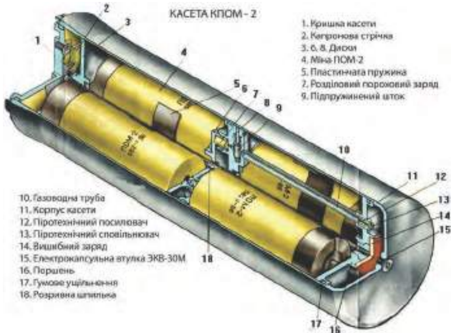
Малюнок 6.7.3 – Касета КПОМ-2, внутрішня будова
