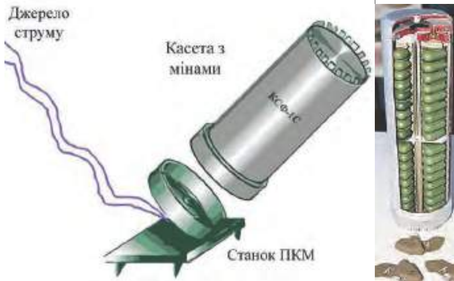
Малюнок 5.6.2 – Касета КСФ-1С: схема та розріз
