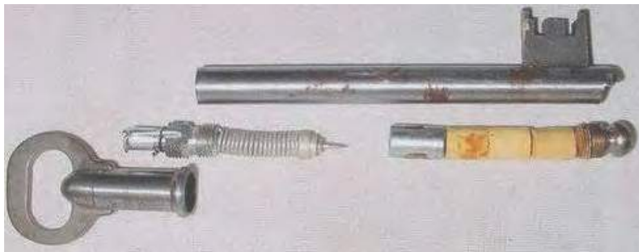
Малюнок 8.10.2 – Детонатор МВ-1, в розібраному стані. Заряд ВР – жовтого кольору
