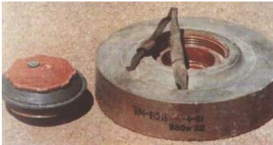
Малюнок 1.9.3 – Міна ТМ-62Б. Добре видно колір, впресовану ручку для переноски; зліва – детонатор МВЧ-62
