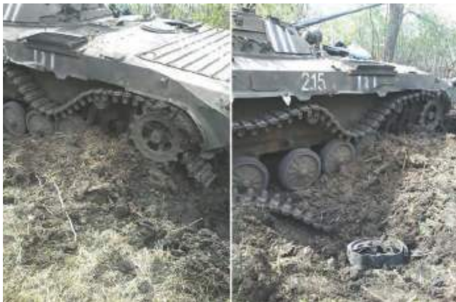
Малюнок 1.7.2 – БМП-2 після підриву на міні ТМ-62ПЗ, зона АТО
