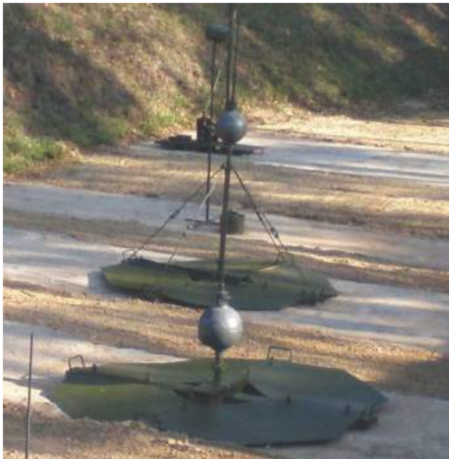
Малюнок 11.3.1 – Міни ПДМ-2, підготовлені до установки, на низькій підставці (на передньому плані) та на високій підставці (на задньому плані). ВР в сфері
