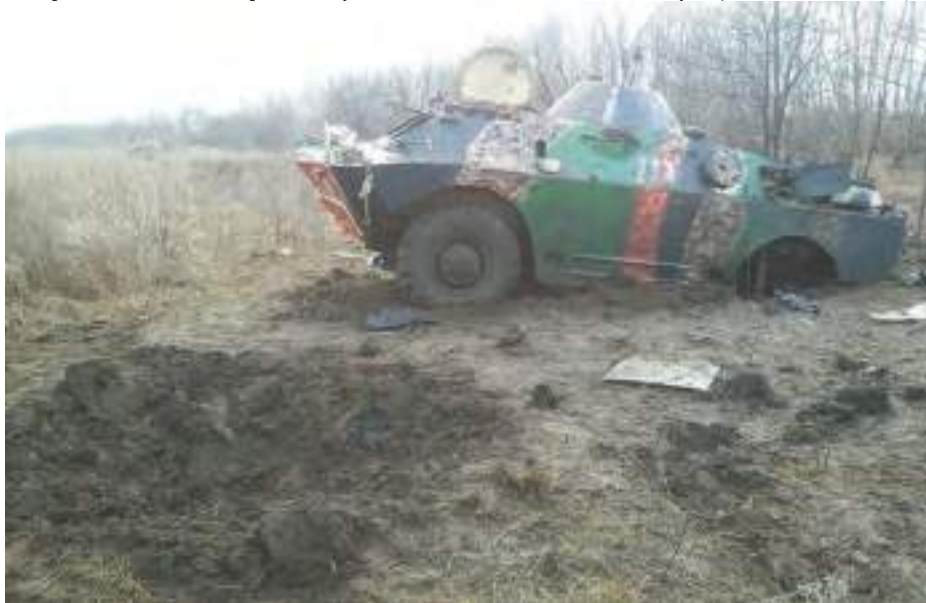
Малюнок 1.9.5 – 03.12.2015 р. Гнутово, Схід України, БРДМ-2 після підриву на міні ТМ-62Б, заднього моста відірвано, 9 ОМПБ
