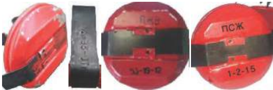
Малюнок 13.4.1 – Зліва – залізнична петарда випуску до 2008 року та маркування на її пружині; В центрі і справа – випуску після 2008 року та їх маркування
