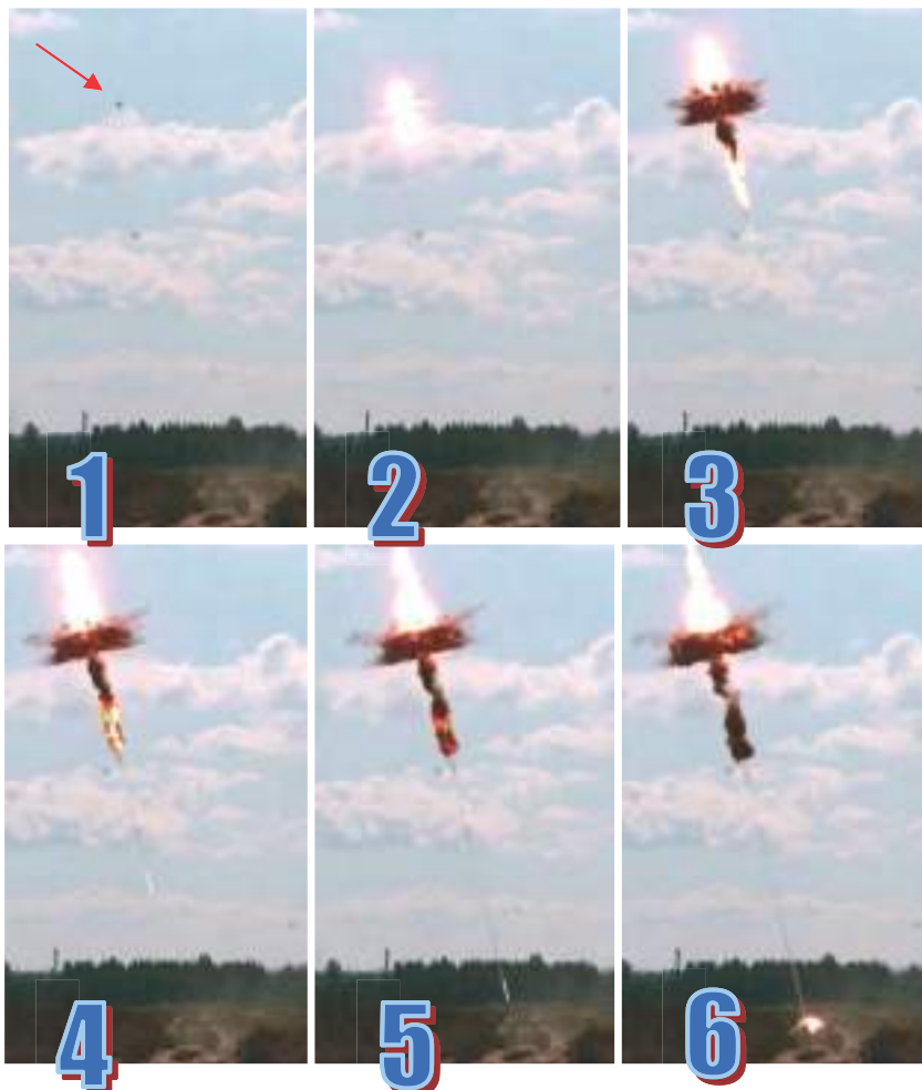
Малюнок 4.2.6 – Відеорозкадрування польоту бойової частини міни: 1 – пошук цілі; 2 – підриг БЧ; 3,4,5 – формування та політ УЯ; 6 – влучання в ціль
