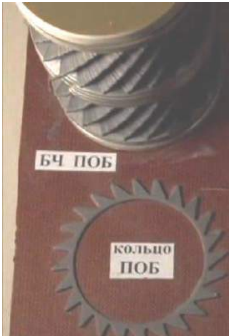
Малюнок 6.9.2 – Сталеві кільця міни ПОВ, з яких, при підриві утримуються осколки
