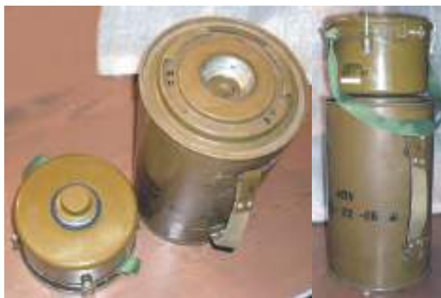
Малюнок 10.1.7 – Міна МЗС в розібраному та зібраному стані
