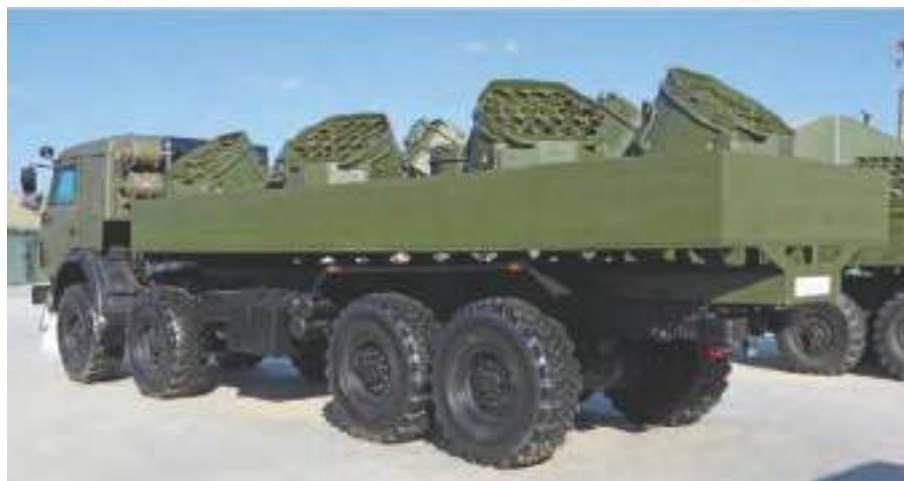
Малюнок 15.1.1 – Мінні загороджувачі УМЗ – зверху, та УМЗ-К – знизу
