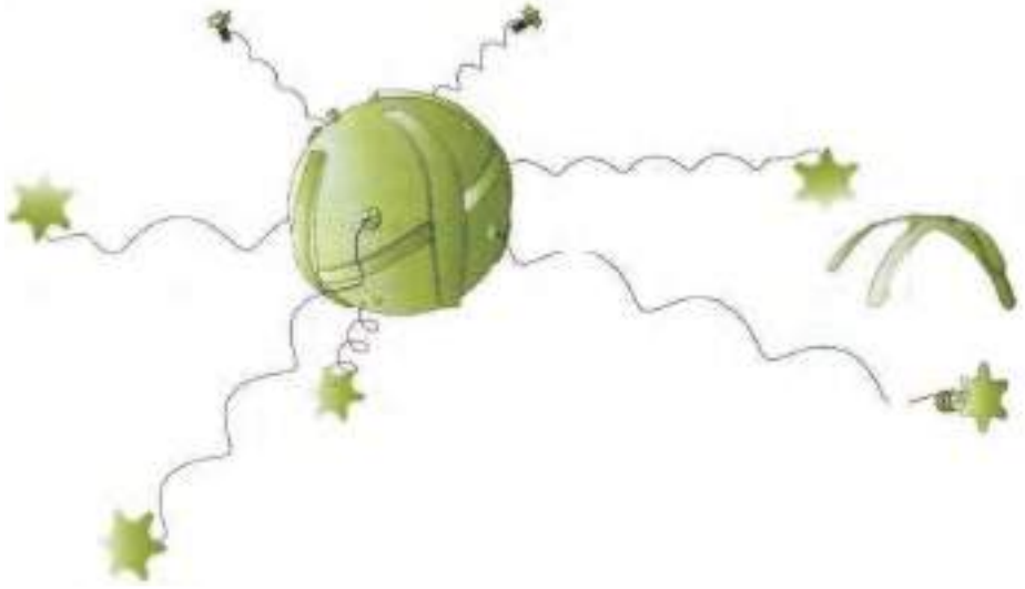
Малюнок 6.6.5 – Міна POM-1 після відкидання якорів-грузиків
