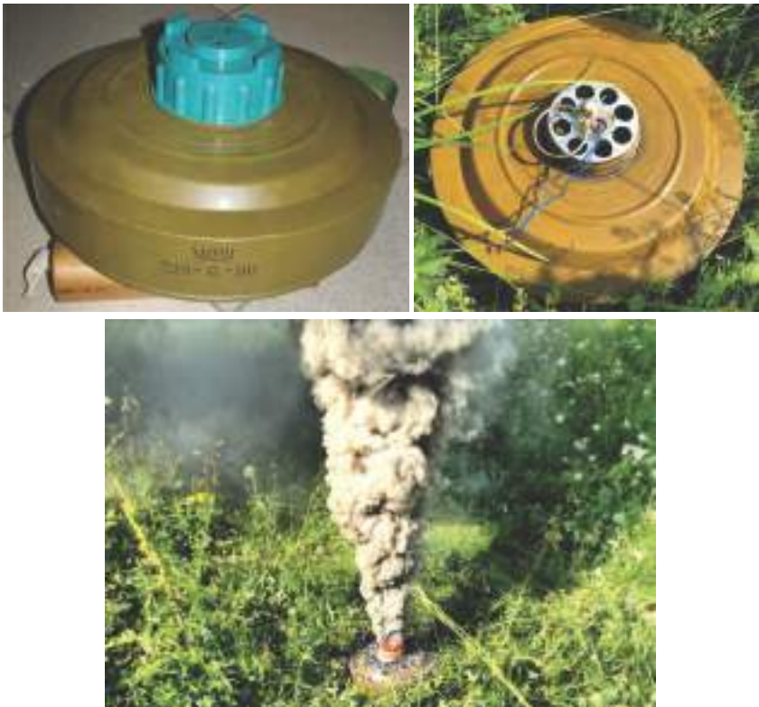
Малюнок 13.5.1 – Зверху-зліва: УДШ з захисним ковпаком; Зверху-справа: УДШ зі знятим ковпаком та підключеним електрокабелем; Знизу: робота УДШ
