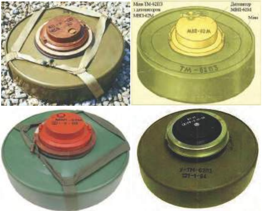
Малюнок 1.7.1 – Міна ТМ-62ПЗ з детонатором МВІІ-62М, ВТ-17 та з'ємною синтетичною ручкою для переноски, варіанти забарвлення
