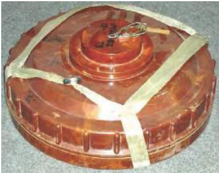
Малюнок 1.6.1 – Міна ТМ-62П2 з детонатором МВП-62 та з'ємною нейлоною ручкою для переноски
