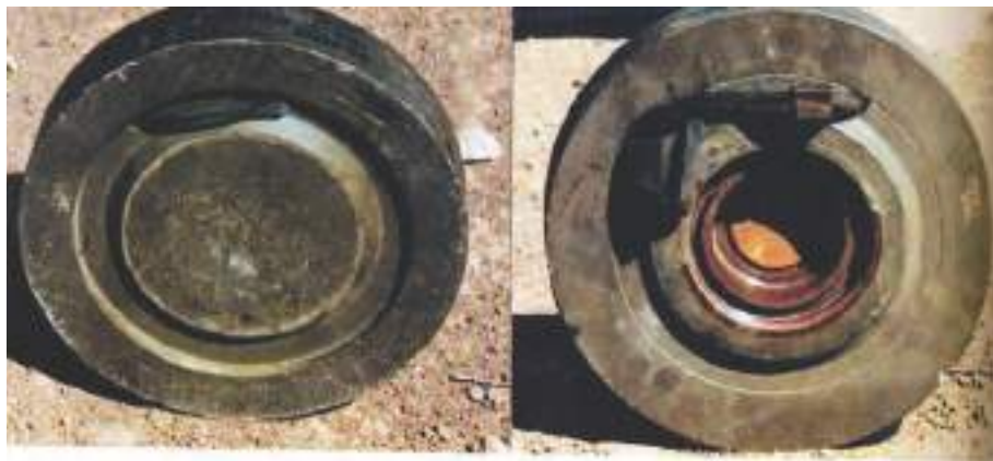
Малюнок 1.9.2 – Міна ТМ-62Б: зліва – вигляд з дна; справа – вигляд зверху, детонатор знято
