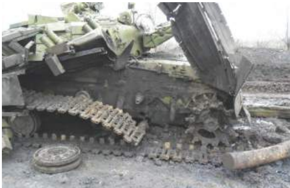
Малюнок 1.8.2 – Т-64ВВ після підриву на міні ТМ-62Т
