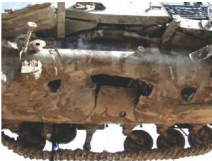
Малюнок 2.1.3 – Израїльський танк «Magach-7» з пробоїною від міни ТМ-72, Південний Ліван
