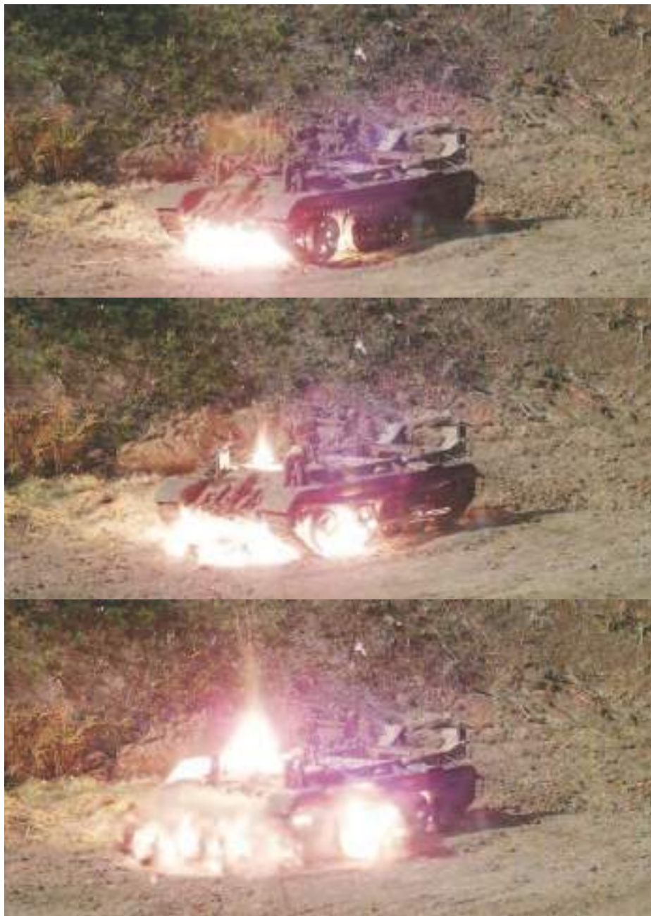
Малюнок 2.1.4 – Відеорозкадрування підриву на міні ТМ-72, з детонатором МВН-72, БРЕМ на базі танка Т-55
