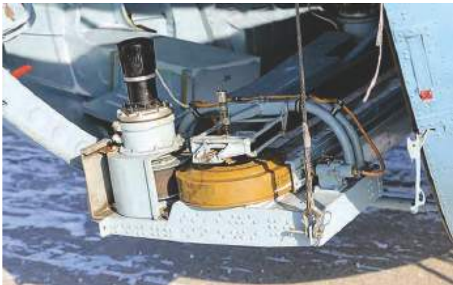
Малюнок 14.2.2 – Гелікоптерна система мінування «Дождь», встановлює одночасно 200 мін. Встановлюється на гелікоптери Мі-8
