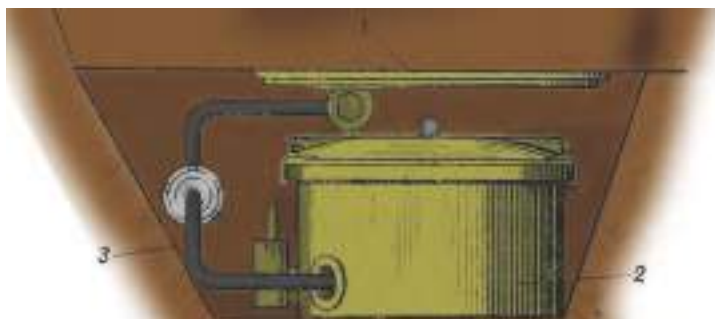
Малюнок 8.4.2 – Встановлення міни МС-6Щ: 1 – протищуповий датчик; 2 – блок управління; 3 – з'єднувальний кабель
