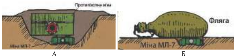
Малюнок 8.8.2 – А: Міна МЛ-7, встановлена в якості пристрою невитягування; Б: Міна МЛ-7, встановлена в якості міні-пастки
