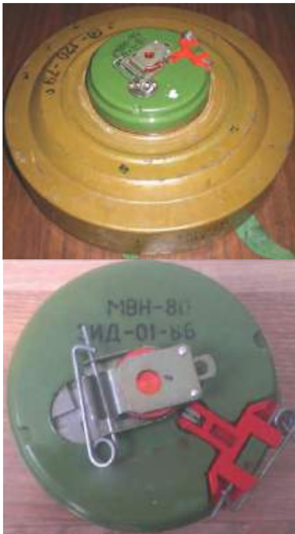
Малюнок 1.4.11 – Міна ТМ-62М з детонатором МВН-80, знизу – детонатор МВН-80
