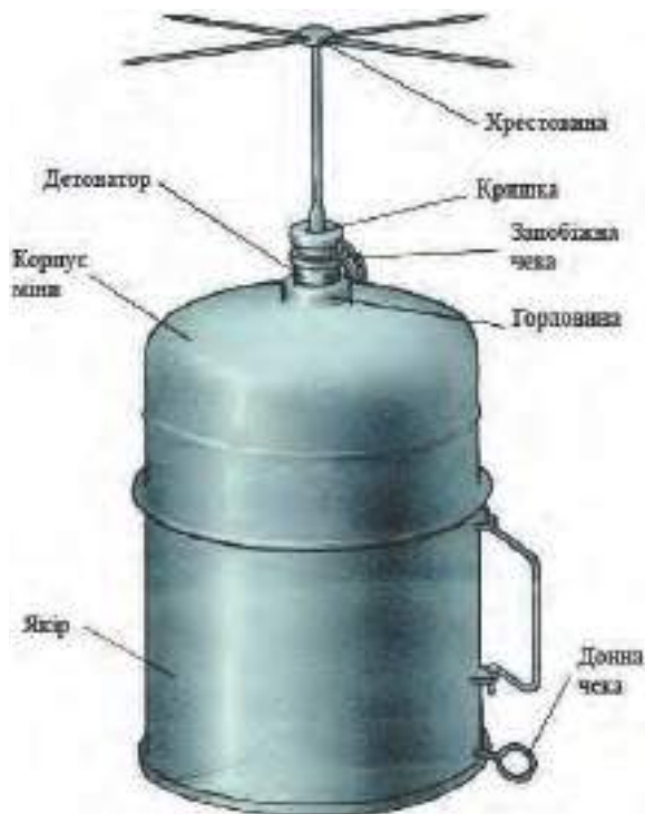
Малюнок 11.1.1 – Міна ЯРМ, загальний вигляд та постановка на якір у воді
