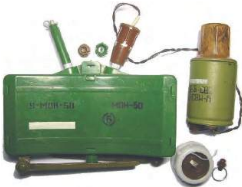
Малюнок 7.3.3 – Міна МОН-50 з детонаторами МВЗ-72 та МВБ
