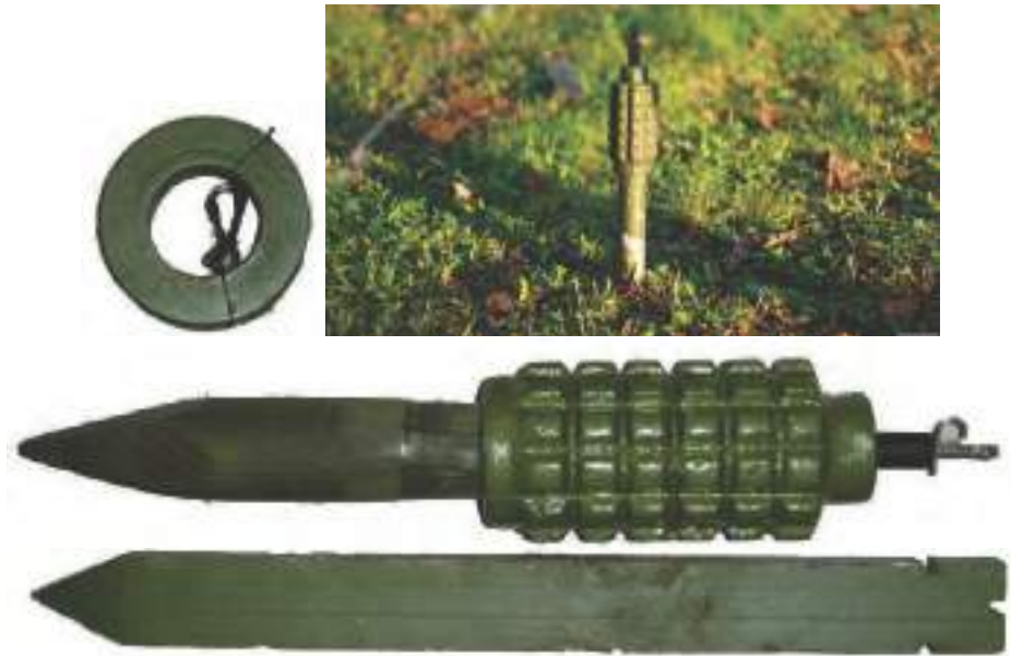
Малюнок 6.1.1 – Міна ПОМЗ-2, з детонатором МУВ, кілком і дротом
