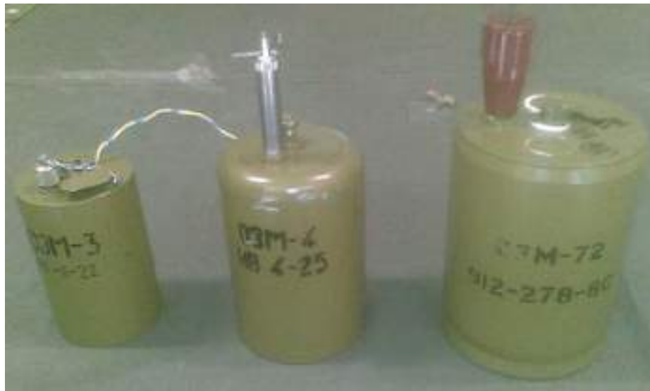
Малюнок 6.5.1 – Міна ОЗМ-72 – справа, з детонатором МВЭ-72, в порівнянні з мени потужнішими ОЗМ-4 (всередині) та ОЗМ-3 (зліва)
