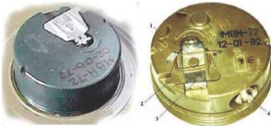
Малюнок 1.4.10 – Детонатор МВН-72. Цифрами зазначено: 1 – шпилька; 2 – відкидна кришка годинникового механізму; 3 – запобіжна чека; 4 – пробка гнізда джерела струму
