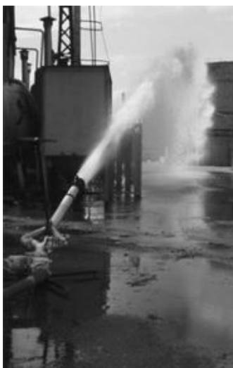
Рисунок 8.5 – Робота СЛК-П20А з насадком Ø 32 мм
