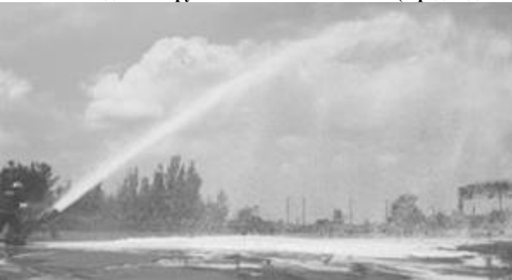
Рисунок 9.37 – Подання струменя ПМП з УГПС-1200 (максимальна дальність)
