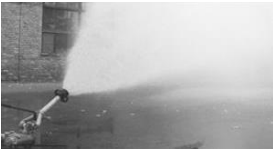
Рисунок 8.8 – Мінімальна дальність подачі водяного струменя
