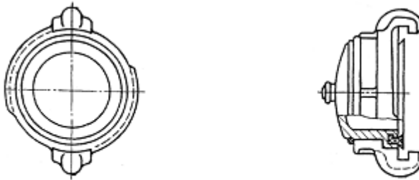
Рисунок 6.5 – Будова головки-заглушки (пожежної)
