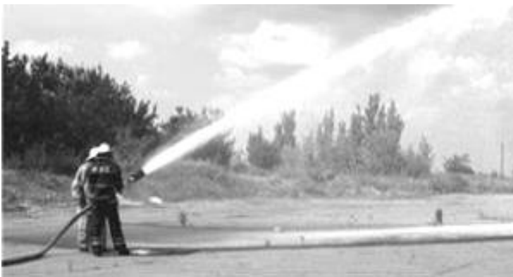
Рисунок 9.25 – Подання струменя ПМП з УГПС-100 (максимальна дальність)
