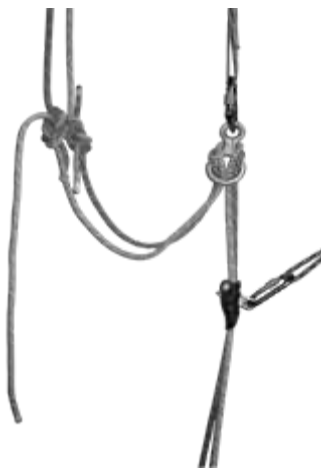
Рисунок 7.6 – З'єднання спускових канатів на вирівнювання довжини їх кінців вузлом «зустрічна вісімка»
