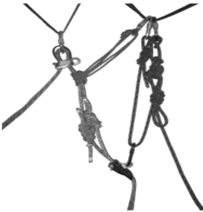
Рисунок 7.9 – Встановлення другого страхувального пристрою
