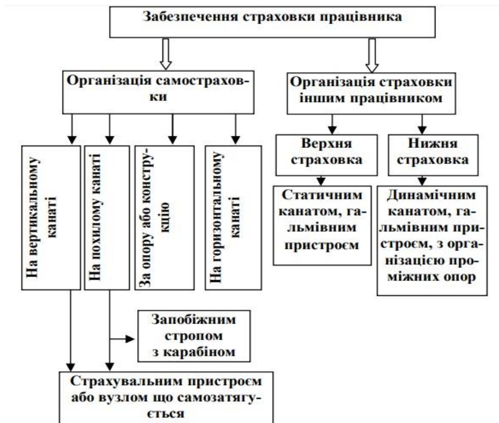
Рисунок 5.3 – Загальна схема організації страховки та самостраховки
