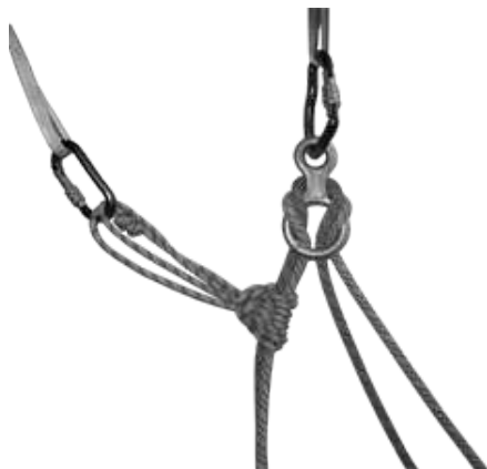
Рисунок 7.4 – Застосування вузлу «схоплюючий» з подвійного репшнура в якості додаткової страховки в АГС.
