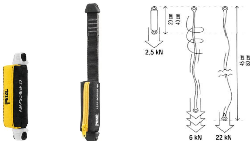
Рисунок 2.34 – Амортизатор ривку «Asap'sorber»
