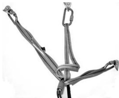
Рисунок 4.35 – «Заклинена» компенсуюча петля
