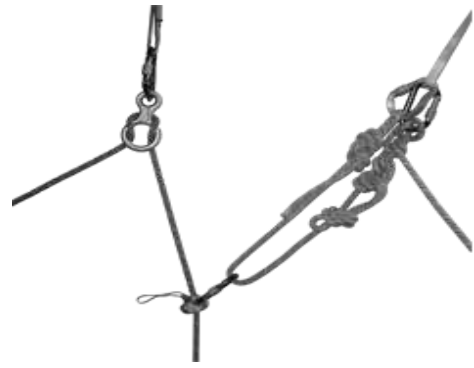
Рисунок 7.5 – Вихідне положення додаткової страховки АГС при подальшому застосуванні прийому «нарощування канатів»
