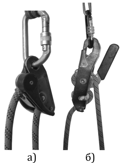
Рисунок 7.3 – Використання страхувальних пристроїв фрикційного типу в якості гальмівного пристрою в АГС:
