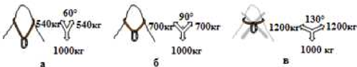
Рисунок 4.10 – Розподіл навантаження на гілки петлі при різних кутах між ними:
