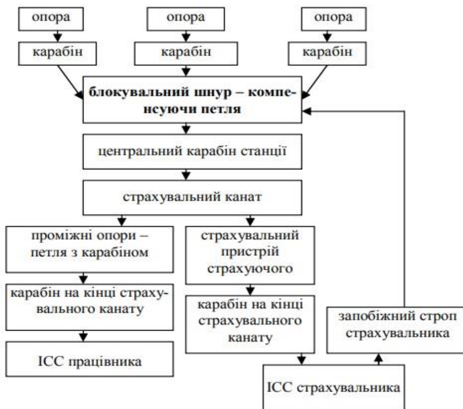
Рисунок 5.2 – Приклад страхувальної ланки при підйомі по елементах конструкцій із нижньою страховкою
