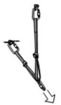
Рисунок 4.34 – Робота компенсуючої петлі при зміні напрямку навантаження
